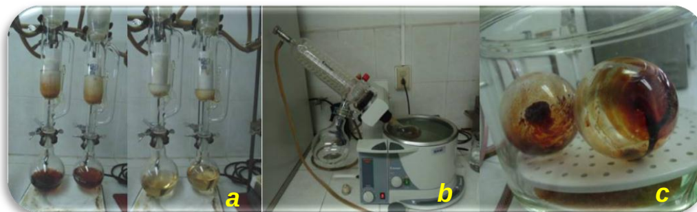
Figura 10. a, Extracción de corteza y madera en equipo Soxhlet. b, Destilación de solventes en rotavapor. c, Extracto en matraces dentro del desecador.
