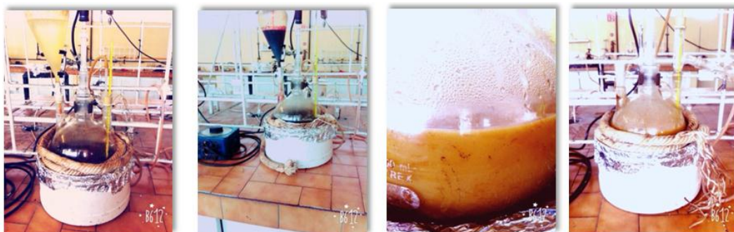
Ilustración 11. Secuencia de la reacción de hidroxilación con \text{KMnO}_4 .
