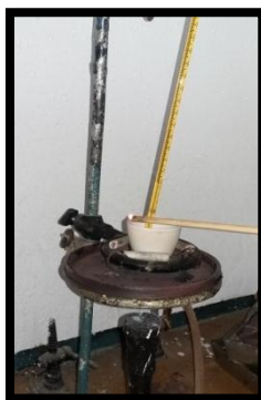
Ilustración 47. Determinación del Punto de Ignición.
