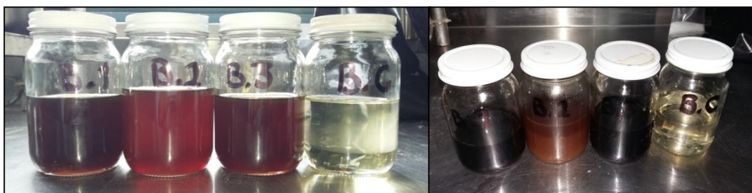
Ilustración 49. Pruebas de Encostramiento; (a) Tiempo: Instante de Preparación, (b) Tiempo: Transcurridas 48 horas.
