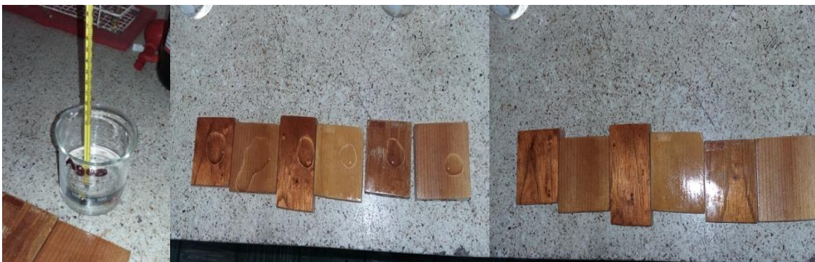
Ilustración 19. Metodología para probar la resistencia de los barnices con diferentes sustancias en las probetas.
