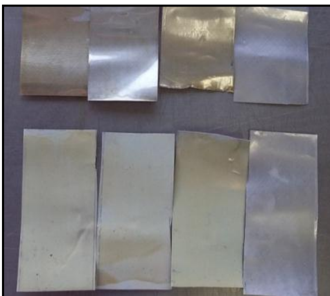
Ilustración 46. Aspecto de las láminas después de la determinación de resistencia al agua mediante inmersión en agua hirviendo por 30 min.
