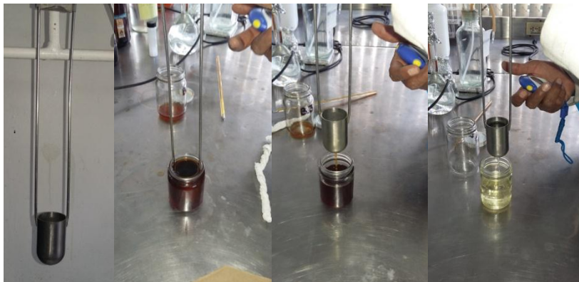
Ilustración 21. Método de Viscosidad Copa Zahn #2.
