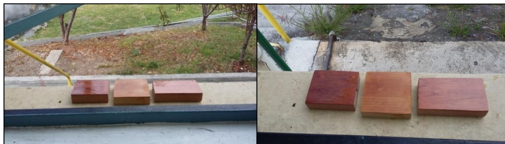
Ilustración 41. (a) Apariencia de las muestras de los Barnices 1,2 y 3 transcurrida una hora después de la 2da. capa.
