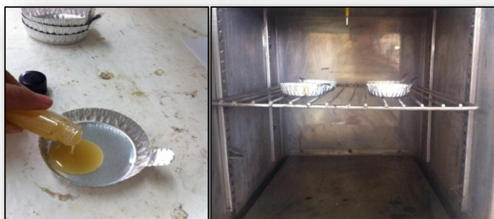
Ilustración 9. Evaporación del Aguarrás de la brea
