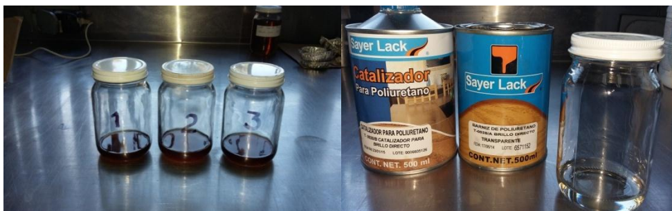
Ilustración 15. Barniz de brea hidroxilada a diferentes concentraciones (a); Barniz Comercial SayerLack brillo directo.
