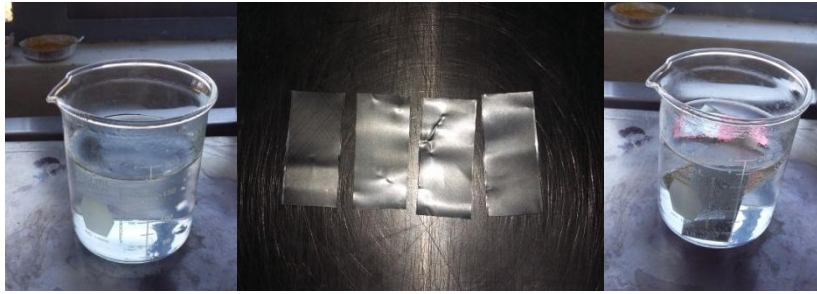
Ilustración 20. Metodología para probar la resistencia extrema al agua.
