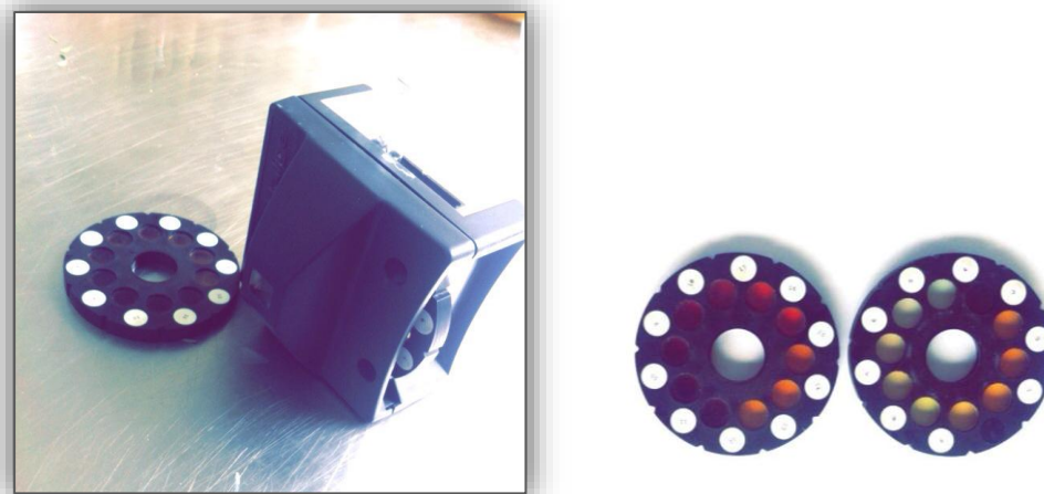
Ilustración 12. Colorímetro Orbeco para determinación de color Gardner.
