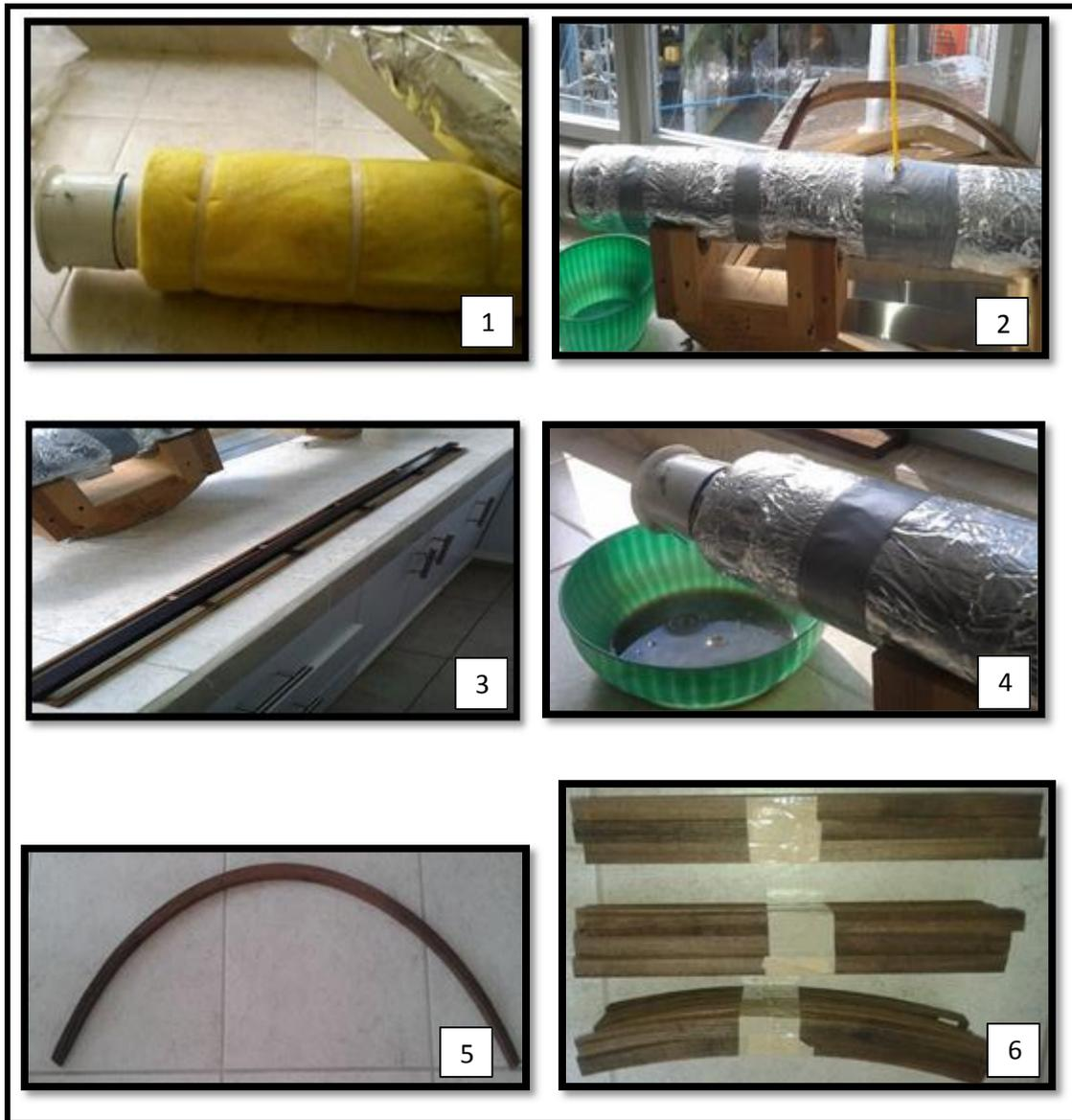
*Figura 1.* Forrado de la cámara con fibra de vidrio. *Figura 2.* Termómetro. *Figura 3* Listón humectado para entrar a la cámara. *Figura 4.* Cámara en funcionamiento. 180 minutos de vaporizado. *Figura 5.* Listón doblado. *Figura 6.* Probetas para evaluación de la calidad del doblado.
