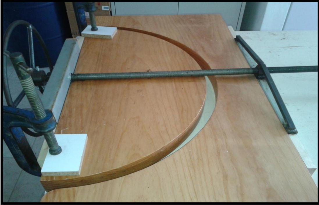
*Figura 18.* Moldes y dispositivo de deformado.
