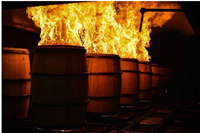
Figura 2.10. Tostado de barricas por el método de gas.
