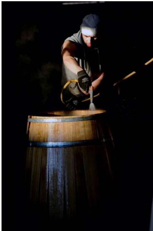
Figura 2.9. Mojado de la madera durante el proceso de tostado.
