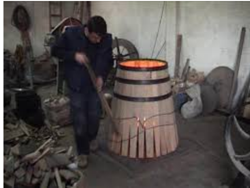
Figura 2.6. Lazo con el que se cierra la parte inferior de la barrica para lograr el curvado final de la barrica.
