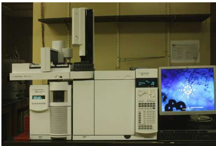
Figura 5.4. Cromatógrafo de gases acoplado a espectrometría de masas, GC/MS Agilent Serie 5975C.
