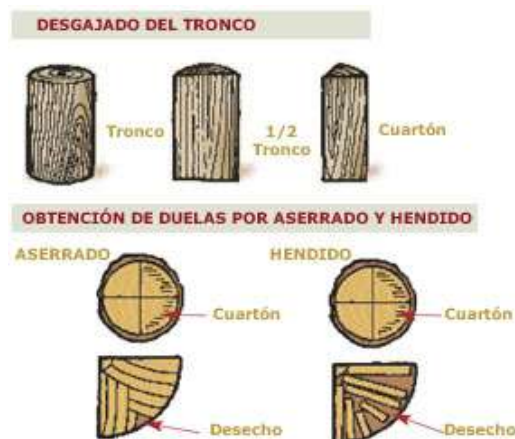
Figura 2.3. Ejemplos de hendido y aserrado de cuarterones.
