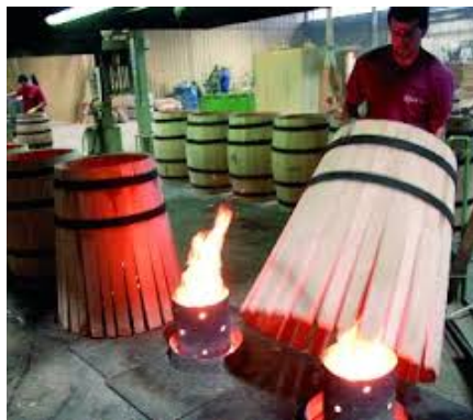
Figura 2.7. Introducción de la barrica al braceró para el inicio del tostado y curvado de la barrica.
