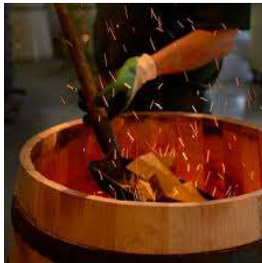
Figura 2.8. Introducción de recortes de madera al bracero interior para el proceso de tostado.
