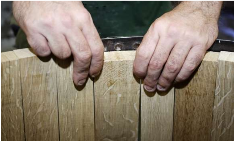
Figura 2.5. Alineación de duelas para el armado de la barrica.
