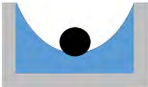
Figura 4.15: Aguja magnética colocada en la superficie del menisco formado sobre el canal al llenar de agua la palangana, la aguja debe quedar de manera paralela al canal para evitar efectos de borde.
