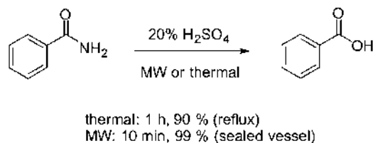
Figura 31. Reacción reportada por Gedye y colaboradores con el uso de microondas en síntesis orgánica.
