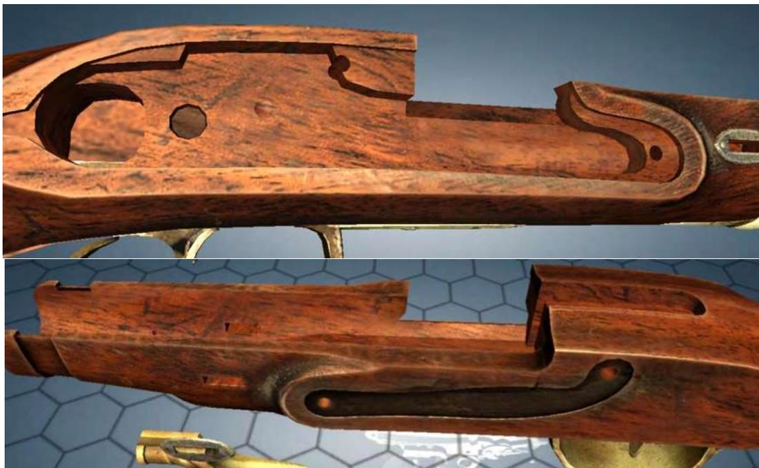
Vaciado de caja: imagen superior se aprecia el hueco de la llave. Imagen inferior, se aprecia el vaciado para el afuste del cañón, así como el hueco de la contrapletina y culata que aseguran la llave y el cañón a la caja. Todas las piezas debían calzar a la perfección para evitar fallas internas especialmente en la llave.<sup>119</sup>
