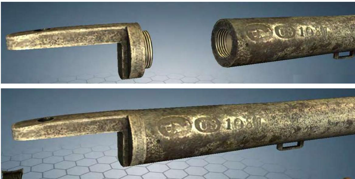
Imagen superior muestra la culata y la cuerda interior cañón antes de obturarse. Imagen inferior muestra la culata cerrando el fondo del cañón formando la recámara. La pestaña superior se conoció como rabera y esta unía el cañón a la caja mediante un tornillo.<sup>107</sup>
