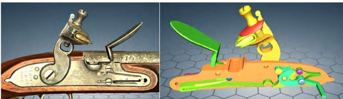
Izquierda: imagen digital de una llave de pedernal montada. Derecha: imagen plastificada del interior de una llave; en su interior se pueden apreciar varias piezas como muelles, brida, nuez y desarmador.<sup>114</sup>
