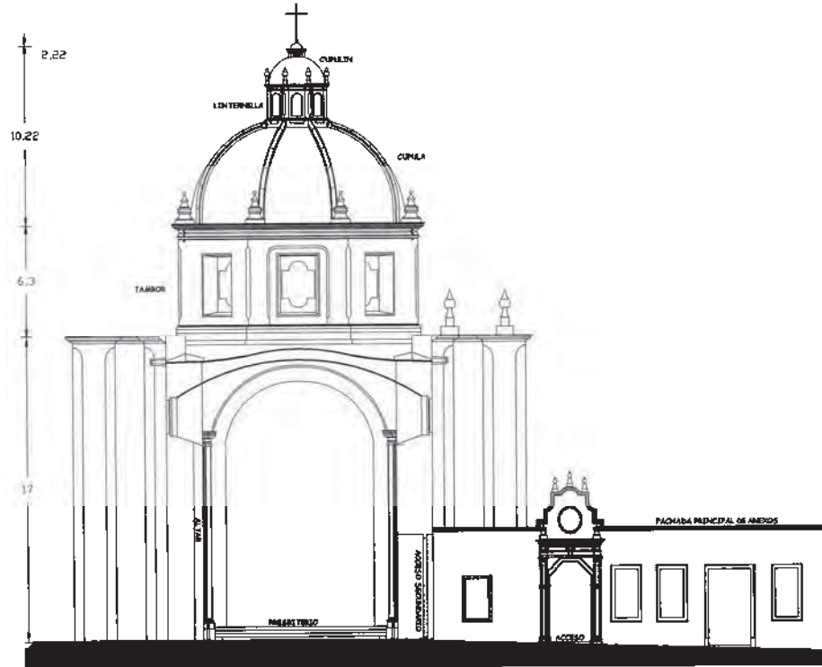
Corte transversal de la bóveda de la nave principal del templo
