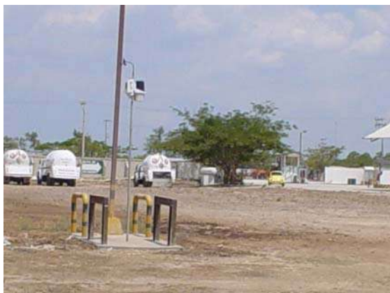
Figuras 47 y 48. ZTU 6. A la izquierda, la estación de la Compañía de Gas Imperial. A la derecha, la estación SEDENA, que en la foto contaba con instrumental Davis que fue cambiado por datalogger Onset. Estas estaciones también se encuentran en el límite de la ciudad en donde predominan las condiciones no urbanas. Las alturas de los instrumentos son de 2.5 m de altura.
