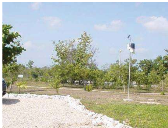
Figuras 47 y 48. ZTU 6. A la izquierda, la estación de la Compañía de Gas Imperial. A la derecha, la estación SEDENA, que en la foto contaba con instrumental Davis que fue cambiado por datalogger Onset. Estas estaciones también se encuentran en el límite de la ciudad en donde predominan las condiciones no urbanas. Las alturas de los instrumentos son de 2.5 m de altura.
