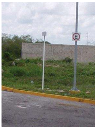
Figuras 8 y 9. Protección contra la energía radiante. A la izquierda una pantalla de Stevenson. Utilizada en las estaciones de la CNA para filtrar el aire y bloquear la energía radiante. A la derecha un protector de energía radiante de los dataloggers Onset.
