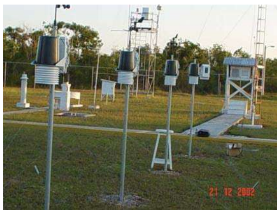
Figuras 3 y 4. Instrumental utilizado. A la izquierda se encuentran cuatro estaciones automáticas, portátiles e inalámbricas, marca Davis, que se utilizaron para medir múltiples variables; la foto corresponde al período en el que se compararon con el instrumental del Observatorio Meteorológico de la CNA. La foto de la derecha presenta dos pequeñas consolas receptoras de los registros de las estaciones y una computadora portátil para recoger y procesar la información generada.
