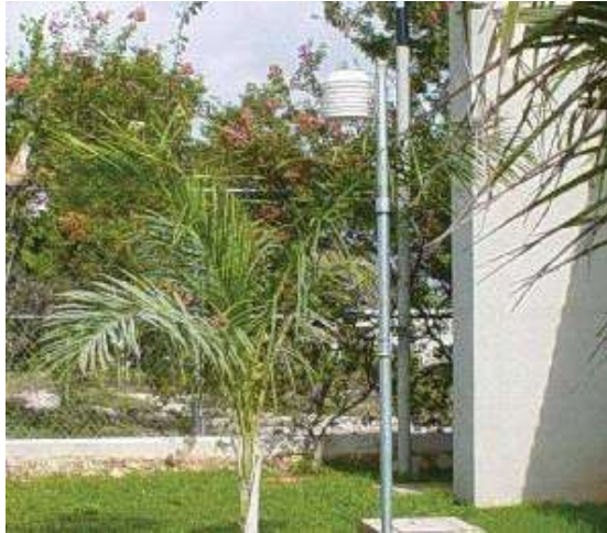
Figura 40. Estación Juan Pablo II. Se encuentra en la colonia del mismo nombre. El instrumento se encuentra en el patio delantero del edificio a 2.2 m de altura y a 2.5 m de la vía pública. Los edificios de la zona son viviendas en su mayoría, con altura de 2.5 m en promedio.
