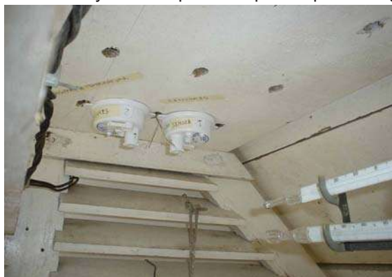
Figuras 5 y 6. Comprobación del instrumental. La figura 5 muestra dos dataloggers de temperatura y humedad durante el período de comparación con los termómetros Lambrecht del observatorio meteorológico de la CONAGUA y la figura 6 la comparación de los dos primeros comparándose con los restantes que se utilizaron en esta investigación.
