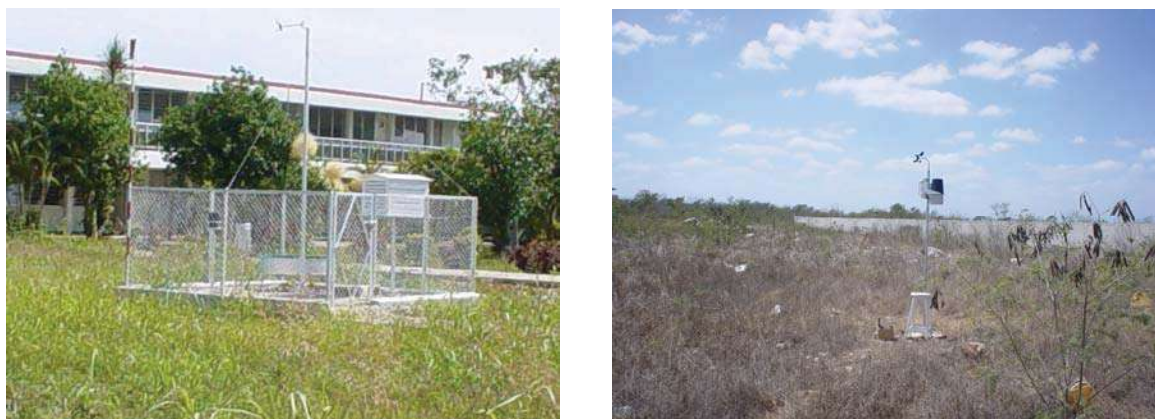
Figuras 45 y 46. Estaciones de la ZTU 6. A la izquierda, la estación que ya existía de la FIUADY. A la derecha, la estación instalada en la compañía PROSEY. Estas estaciones se encuentran en el límite de la ciudad, en donde predominan las condiciones no urbanas. La colocación de los instrumentos responde a las condiciones de la zona; sus alturas son de 1.8 y 2.2 m de altura.
