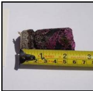
Figura 63. Secuencia fotográfica que muestra la detección de la armadura, extracción de los núcleos, medición de la profundidad carbonatación y resane de las columnas del hotel Alameda. (E. Paredes, 2011).
