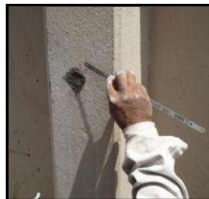
Figura 63. Secuencia fotográfica que muestra la detección de la armadura, extracción de los núcleos, medición de la profundidad carbonatación y resane de las columnas del hotel Alameda. (E. Paredes, 2011).
