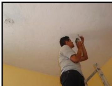
Figura 81. Determinación de la ubicación de acero de refuerzo y de la resistencia a compresión de los elementos estructurales del centro escolar Independencia. (E. Paredes, 2010).
