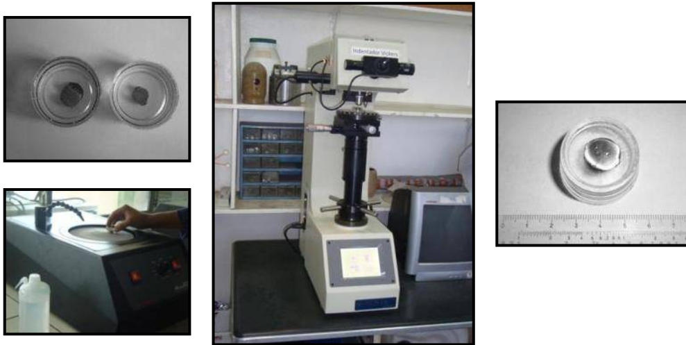
Figura 28. Prueba de microdureza Vickers en muestras de acero. (E. Paredes, 2010).
