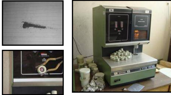
Figura 29. Obtención del contenido de carbono y azufre en muestras de acero. (E. Paredes, 2010).
