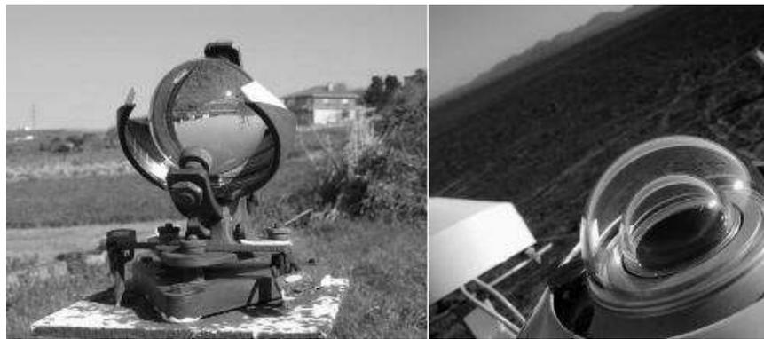
Figura 18. Heliógrafo de Campbell-Stokes (izquierda) y piranómetros de cúpula (derecha). Fuente: [www.tiempo.com](http://www.tiempo.com)
