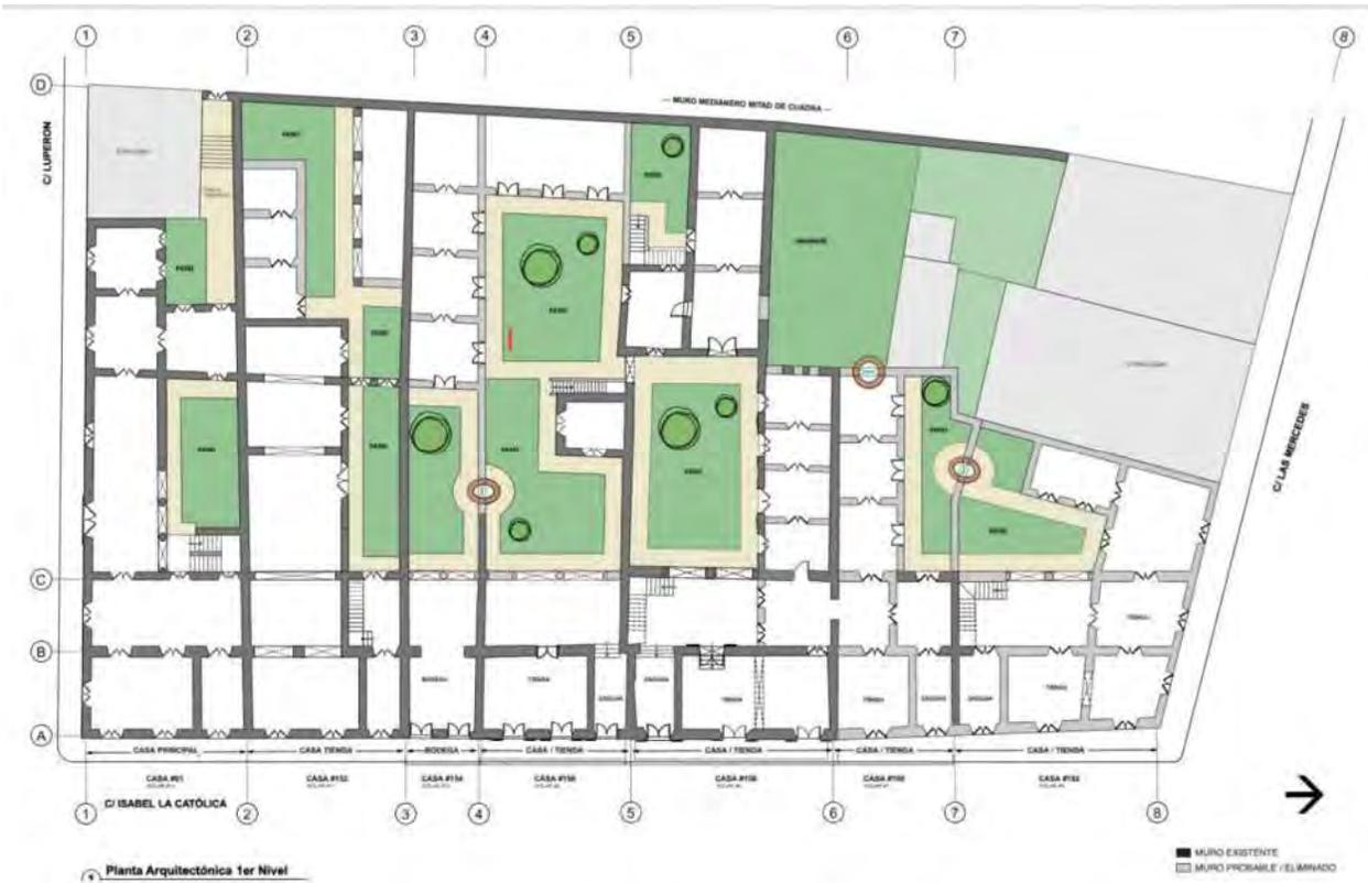
**Figura 5. 33.** Planta de conjunto de casas presentando un esquema hipotético de las casas de Diego Caballero. En negro muros existentes; en gris muros modificados; en blanco posibles muros que se pueden mostrar para dar una idea del esquema original de las casas en conjunto. Fuente: Elaboración propia. Dibujo Danae Peguero.
