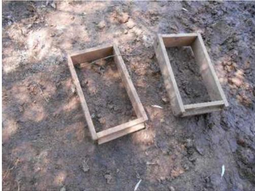
Figura 29. Moldes utilizados para la fabricación de ladrillo, Erongarícuaro, Michoacán.
