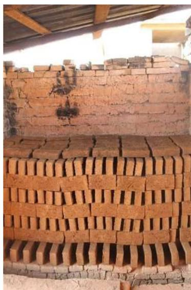
Figura 36. Apilado de ladrillo en horno, preparado para cocción, Tzurumútar,
