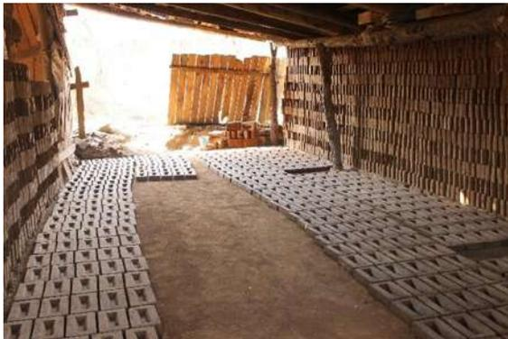
Figura 31. Proceso de secado de tabique bajo cubierta, Erongarícuaro, Michoacán.
