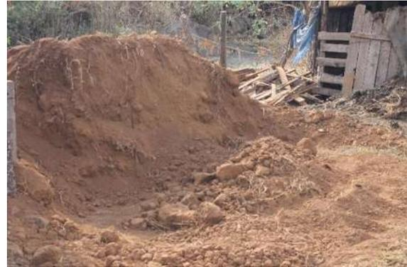
Figura 30. Tierra utilizada para la fabricación del tabique y ladrillo, Erongarícuaro, Michoacán.
