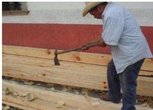
Figura 8. Proceso de hachueleado en vigas de madera, Angahuan, Michoacán.
