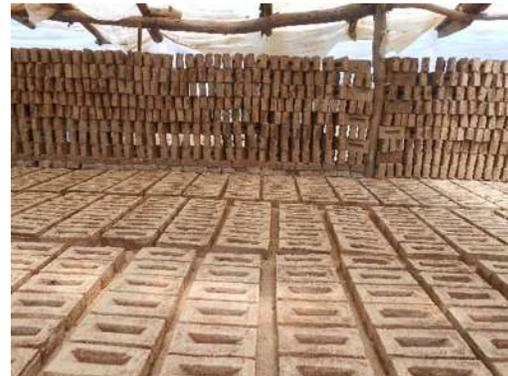
Figura 32. Proceso de secado de tabique bajo cubierta, Erongarícuaro.
