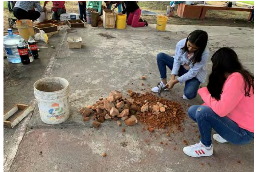
293_ Gómez Miguel. (2020). Trituración de escombro
