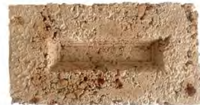
MEZCLA 5 1 Cemento bco + 4 Escombro Costo: $3.50
