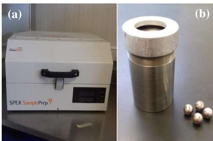
Figura 16. a) Molino de alta energía. b) Vial y balines de acero.
