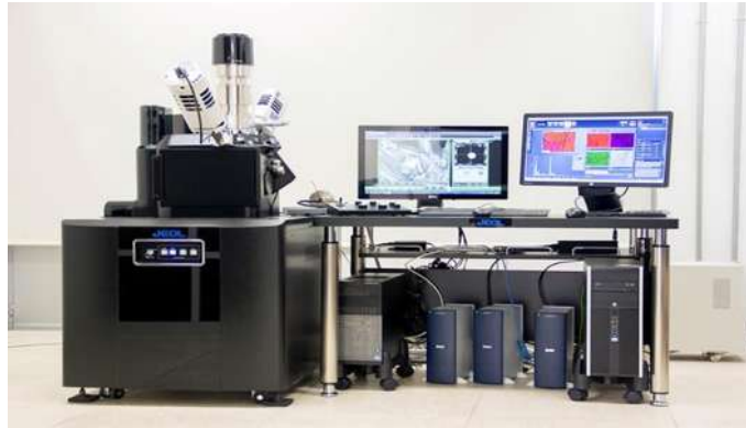
Figura 22. Microscopio electrónico de barrido (SEM). Equipado con microanálisis de rayos X (EDS, Energy Dispersive Spectrometry)
