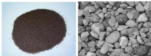
Figura 1.5: Primer plano de agregado fino y agregado grueso.
