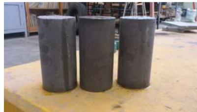
Figura 3.8: Cilindros de concreto elaborados en laboratorio y prueba a compresión simple
