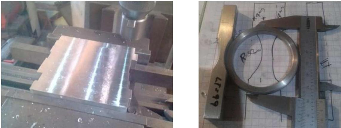
Figura 4.18 Material base y probeta muestra
