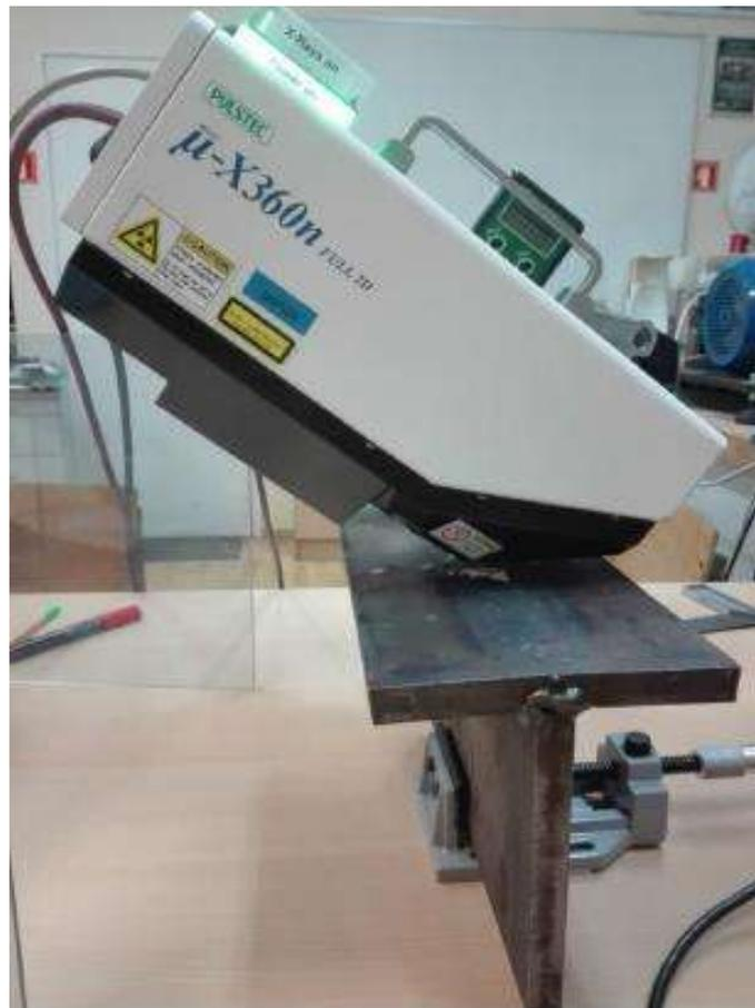
**Figura 2.1** Dispositivo Pulstec  $\mu$ -X360 para medir esfuerzos residuales [51]
