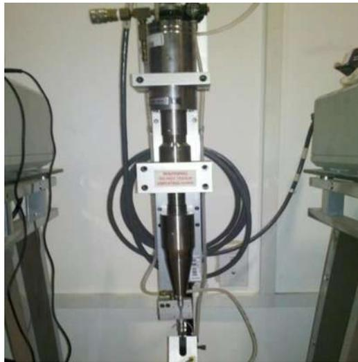
**Figura 2.6** Piezoeléctrico y multiplicador de desplazamiento.
