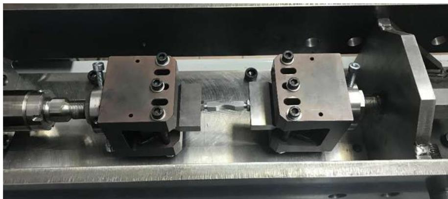
Figura 4.25 Probeta montada en la máquina de fatiga convencional
