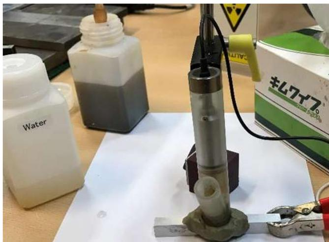
Figura 4.30 Electro pulido en las probetas para medir esfuerzos residuales
