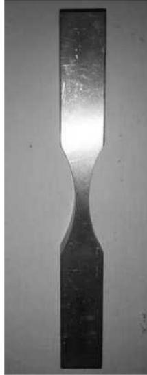
**Figura 4.21** Probeta lista para ser montada en la máquina ultrasónica.
