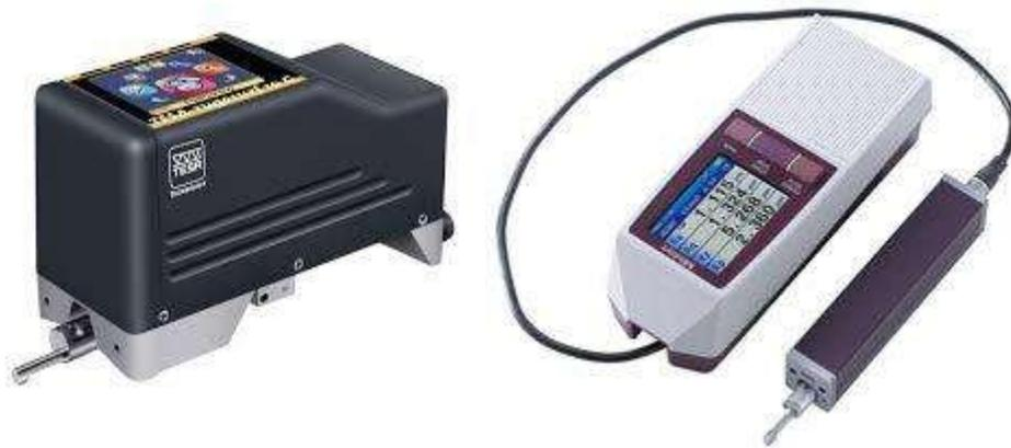
**Figura 2.2** Medidores de rugosidad TESA y Mitutoyo respectivamente
