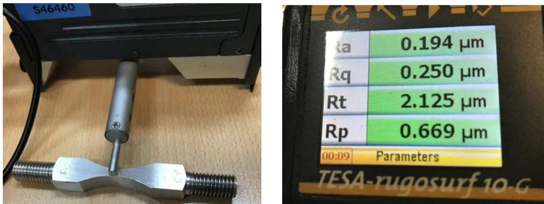
**Figura 4.26** Probeta durante mediciones de rugosidad y display de valores obtenidos por el instrumento
