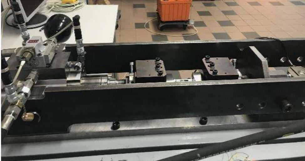
**Figura 2.5** Vista lateral de la máquina Servo-hidráulica de fatiga
