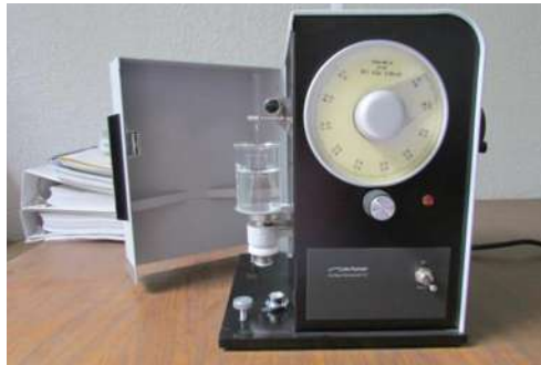
Figura 3. 3 Tensiómetro semiautomático Cole-Parmer para medir la tensión superficial del líquido alimentado a la columna de flotación.
