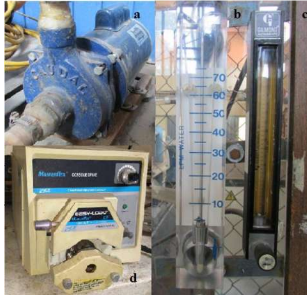
Figura 3. 2 Equipo periférico para medir y controlar los flujos de aire y agua en cada corriente (a) Bomba centrífuga; (b) Rotámetro para líquidos; (c) Rotámetro para gas; (d) Bomba peristáltica.
