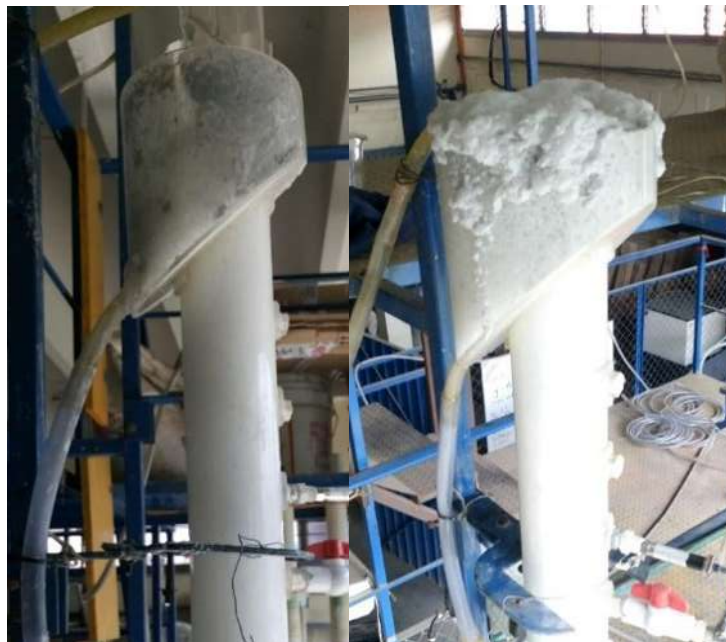
Figura 3. 4 Evidencia de la separación de tinta del papel en la columna de flotación y su salida con la espuma por la parte superior de la misma.
