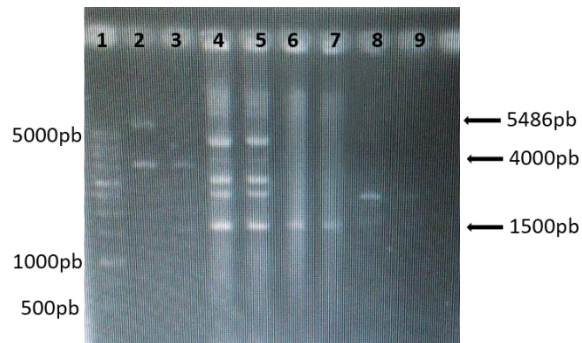
Fig. 31. Electroforesis en gel de agarosa de digestión con las enzimas de restricción PvuI y KpnI . Carril 1: marcador de peso molecular. Carril 2: pfnlyskD3. Carril 3: pfnlyskD3 digerido. Carril 4: pfnvD3. Carril 5: pfnvD3 digerido. Carril 6 pfnvD4. Carril 7: pfnvD4 digerido. Carril 8: pfnvD5. Carril 9: pfnvD5 digerido
