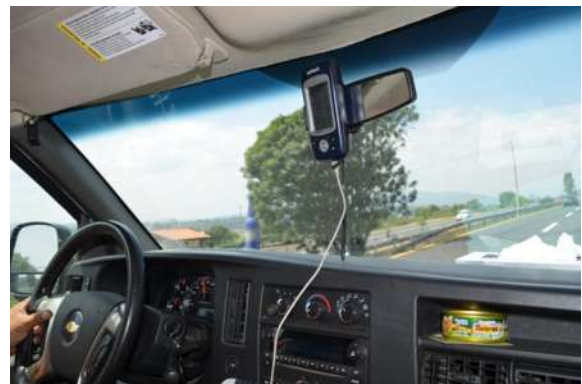
Foto 2.7 y 2.8 Computadora para registrar las mediciones y GPS para georeferenciar la información del Mu Meter.
