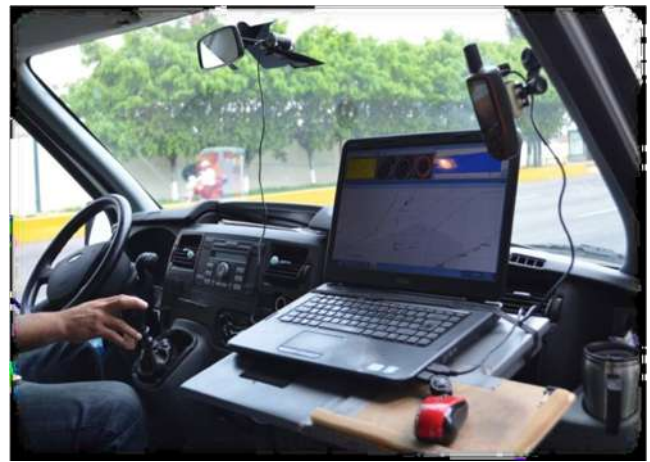
Fotos 4.6 y 4.7 Computadoras para monitoreo y computadora portátil, para inventario de elementos de la infraestructura y GPS.
