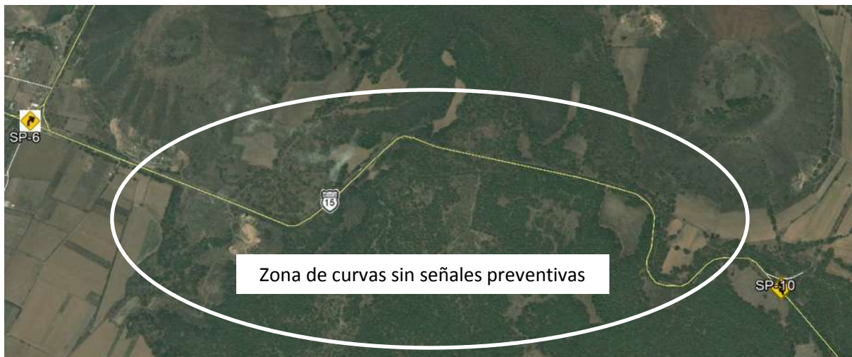
Figura 5.18. Ausencia de señales preventivas en curva.
