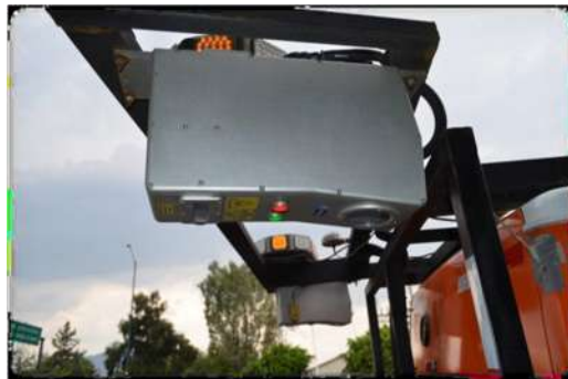
Foto 4.5 Sensores laser dinámicos con cámaras fotográficas, para determinar IRI, Deterioros y Deflexiones.
