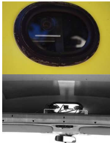
Foto 2.24 y 2.25 Cámaras con las cuenta el vehículo para la toma de imágenes
