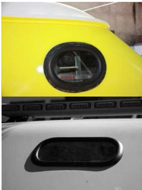
Foto 2.24 y 2.25 Cámaras con las cuenta el vehículo para la toma de imágenes
