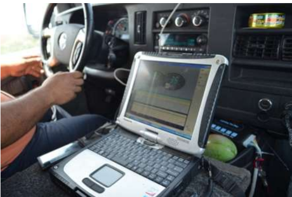
Foto 2.7 y 2.8 Computadora para registrar las mediciones y GPS para georeferenciar la información del Mu Meter.
