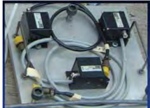
Figura 5.41 Sensores uniaxiales.
