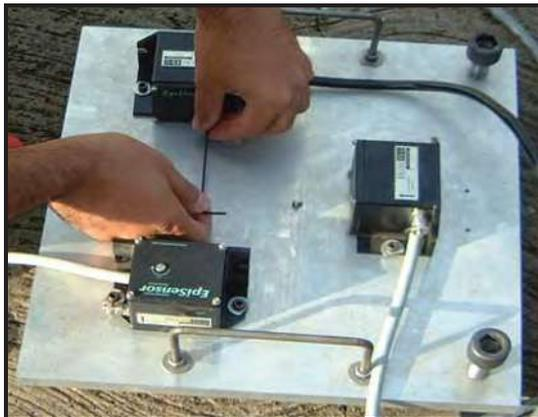
Figura 5.44 Calibración de los sensores.
