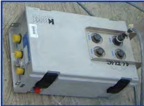
Figura 5.40 Equipo Altus K2 con salida a 12 canales.
