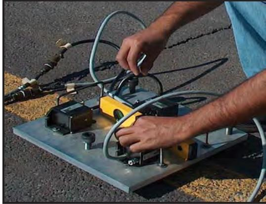
Figura 5.43 Nivelación de la placa donde se localizan los sensores.
