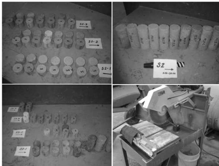
FIG. 3-26 ESPECÍMENES FABRICADOS PARA LOS ENSAYOS EN ROCAS
