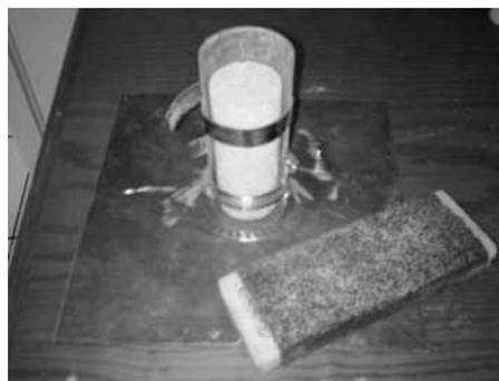
FIG. 3-31 DISPOSITIVO FABRICADO PARA LOGRAR EL CABECEO DE LAS PROBETAS
