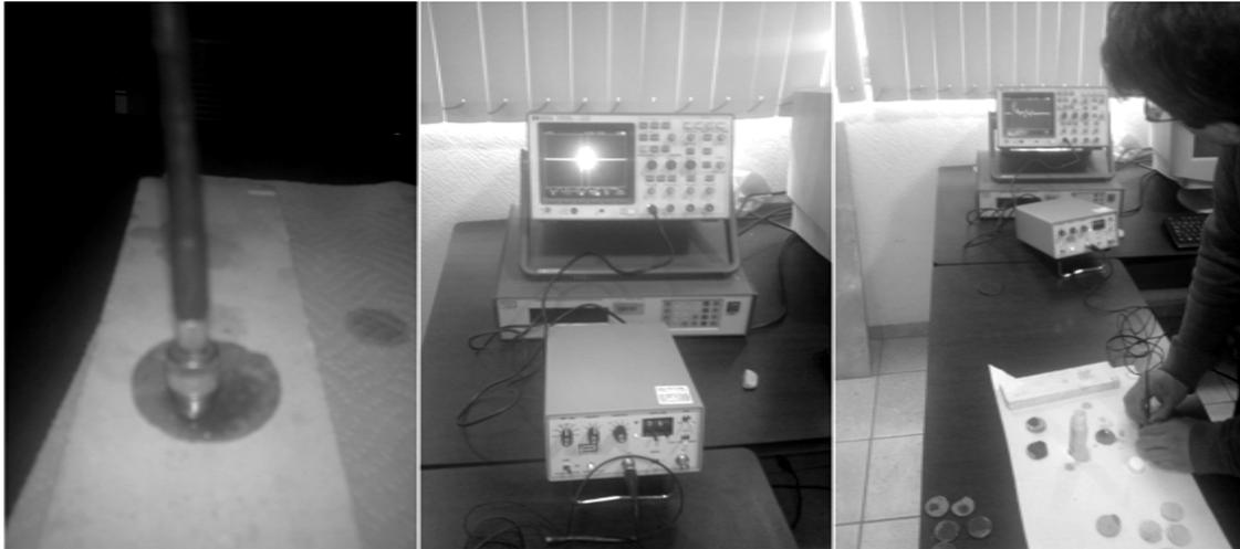
FIG. 3-34 DISPOSITIVO UTILIZADO EN LA PRUEBA DE VELOCIDAD DE ONDA SÓNICA
