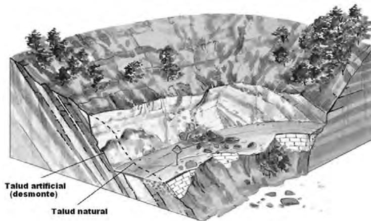
FIG. 1-2 INTERACCIÓN DE TALUDES NATURALES Y ARTIFICIALES EN UN TRAMO CARRETERO (MODIFICADO DE SUÁREZ, 2007)
