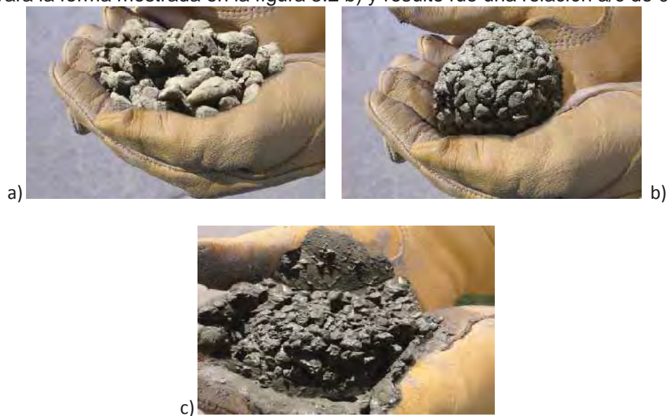
Fig. 3.2 Ejemplos de concreto permeable elaborados con diferente contenido de agua y formando una bolita: a) Muy poca agua, b) poco contenido de agua y c) Mucho contenido de agua. (Brown, D., 2003).
