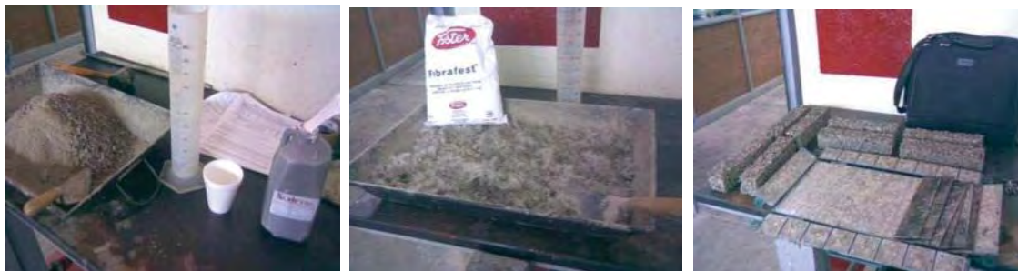
Fig. 4.4 Fabricación y desmolde de vigas.
