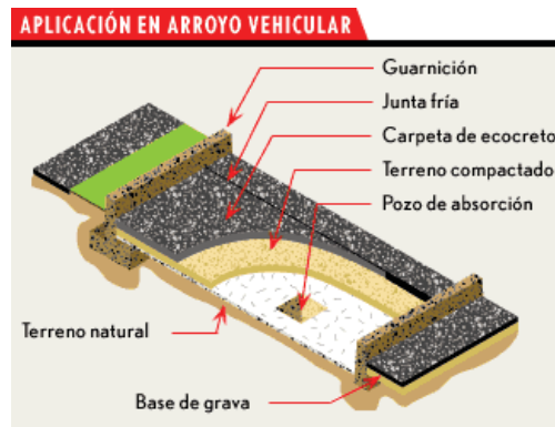
Fig. 1.2.-Componentes del pavimento permeable (De Buen, 2005)
