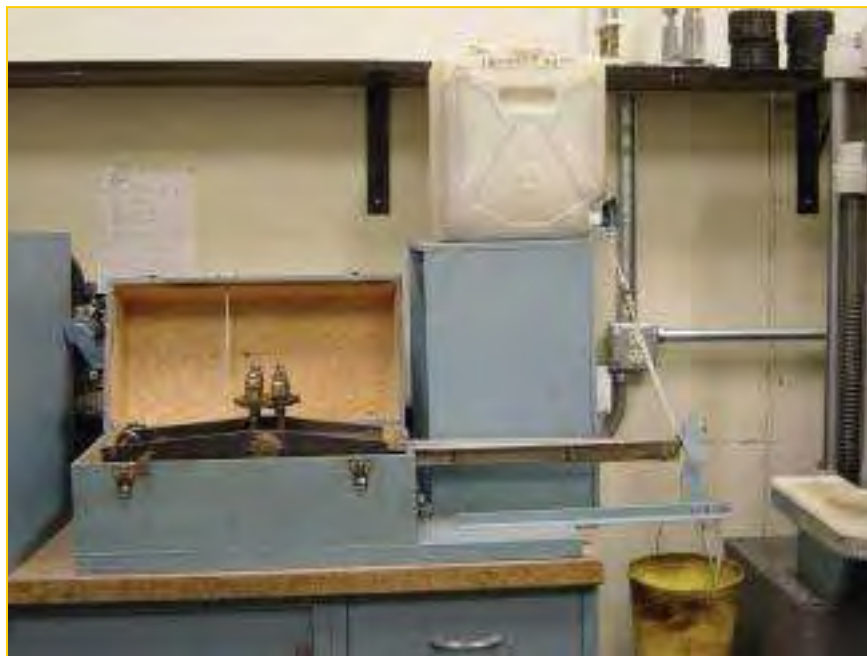
Fig. 4.23: Cohesímetro de Hveem
