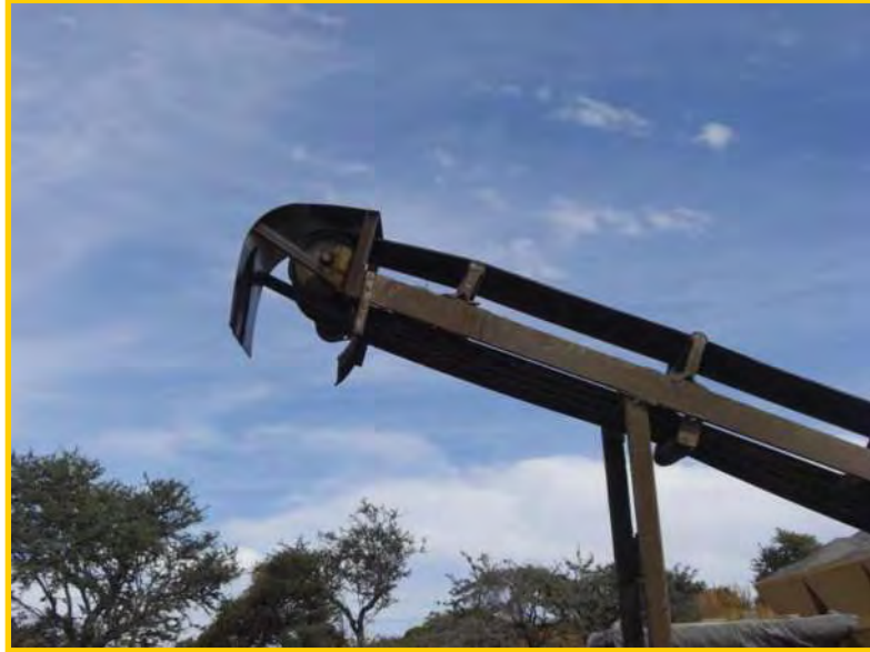
Fig. 6.24: Dispositivo de carga para evitar clasificación del material, implementado a partir del 4 de enero de 2010.
