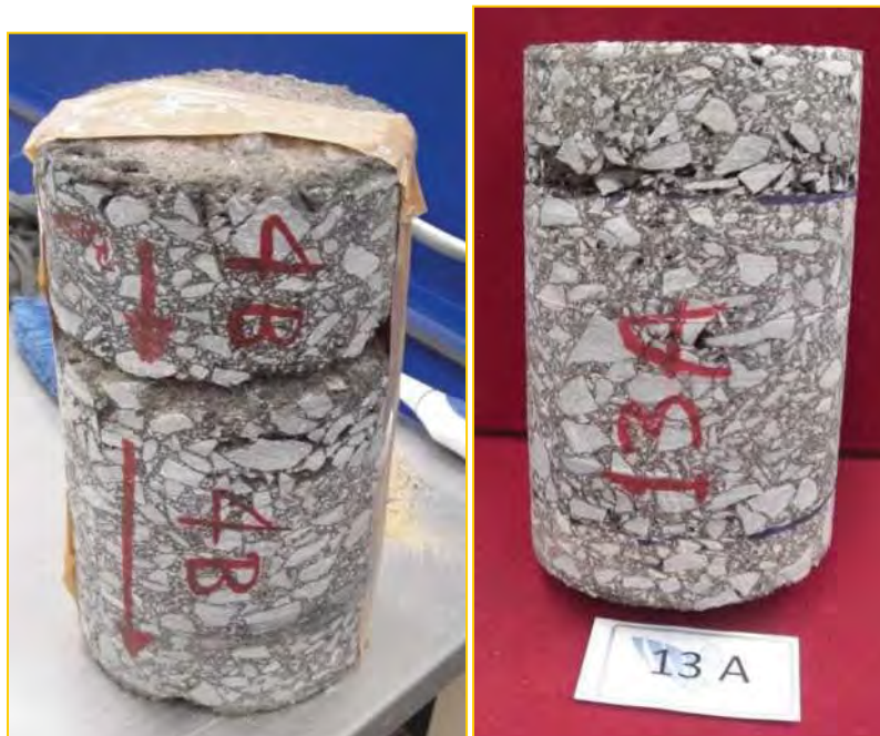
Fig. 6.29: Corazones extraídos del tramo, se aprecia la falta de liga.
