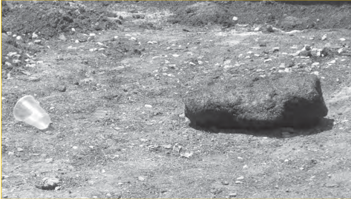
Fig. 6.22: Terrón de mezcla asfáltica detectado el 27 de marzo de 2010 con aproximadamente 35cm de longitud.
