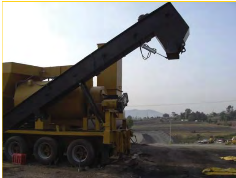
Fig. 6.25: Dispositivo de carga requerido para minimizar la clasificación del material, en plantas de producción continua.
