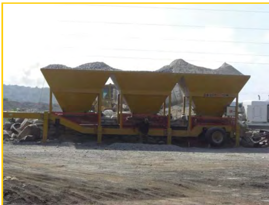
Fig. 6.20: Tolvas de material pétreo en frío. Se observa que hay traslado de materiales entre las diferentes tolvas.
