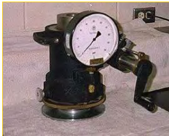
Fig. 4.24: Estabilómetro de Hveem.
