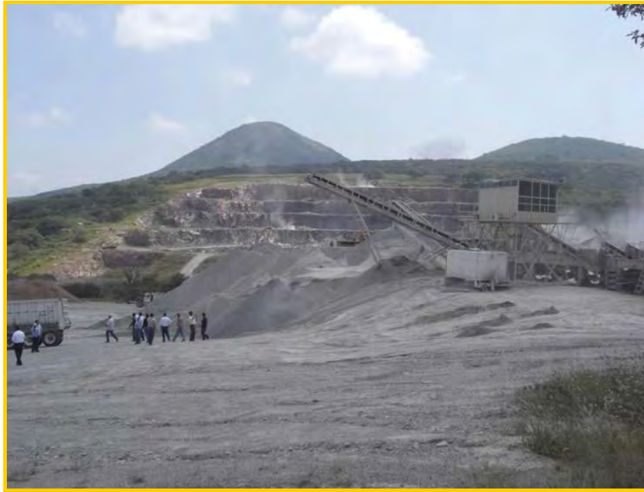
Fig. 6.15: Banco GRAVASE; al fondo se observa el frente de extracción, a la derecha se observa la trituradora con sus respectivas bandas que clasifican el material según el tamaño.
