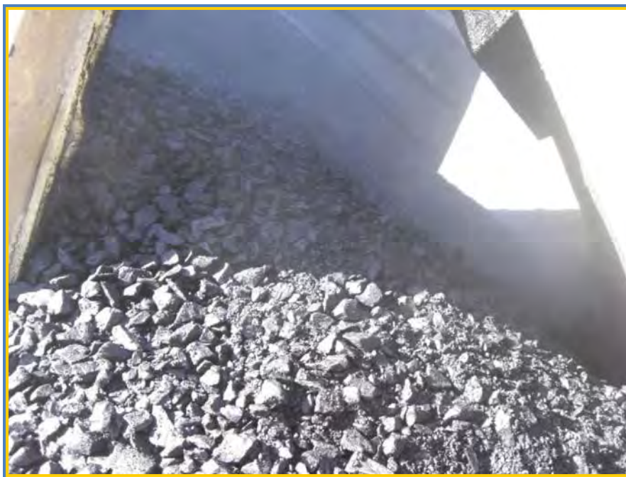
Fig. 6.31: Clasificación de material en el camión, la mitad material grueso y la otra mitad material fino.
