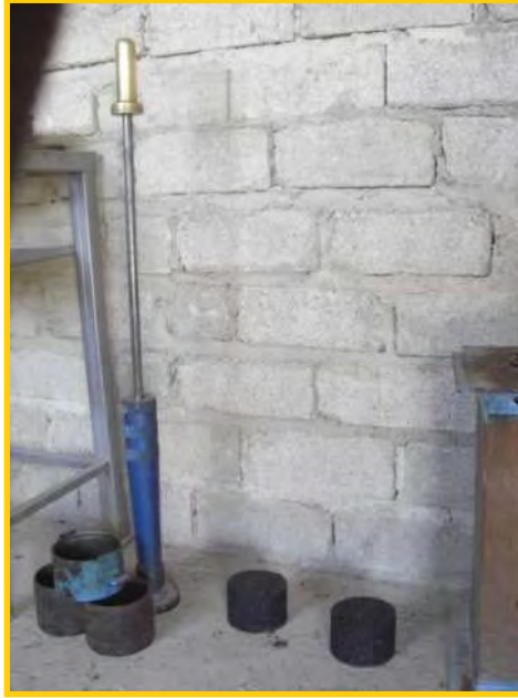
Fig. 6.27: Control de calidad en mezcla densa con compactador Marshall.
