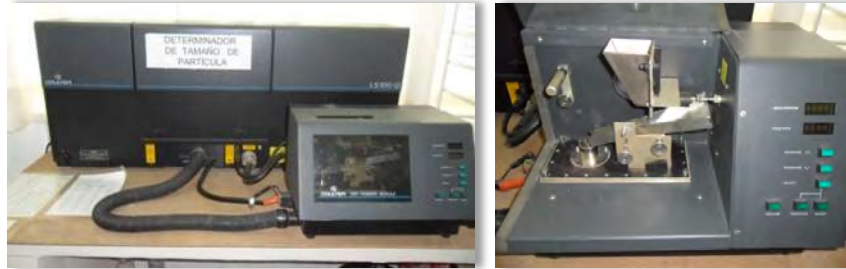
Figura 4.1. 7. Analizador de partículas láser COULTER modelo LS100Q
