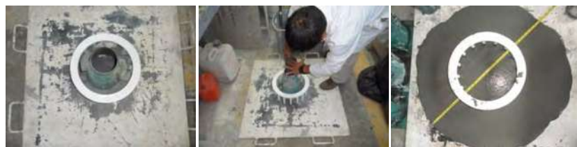
Figura 4.2. 4. Proceso de ensayo de extensibilidad con el J-Ring
