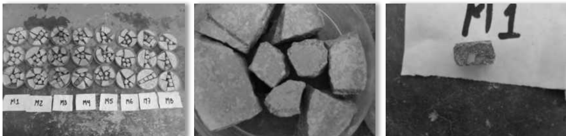
Figura 5.5. 3. Labrado de los cubitos y la selección de la mejor muestra.
