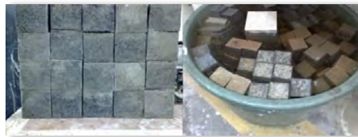
Figura 3.2. 4. Desmoldado de los cubos y curado de los mismos.
