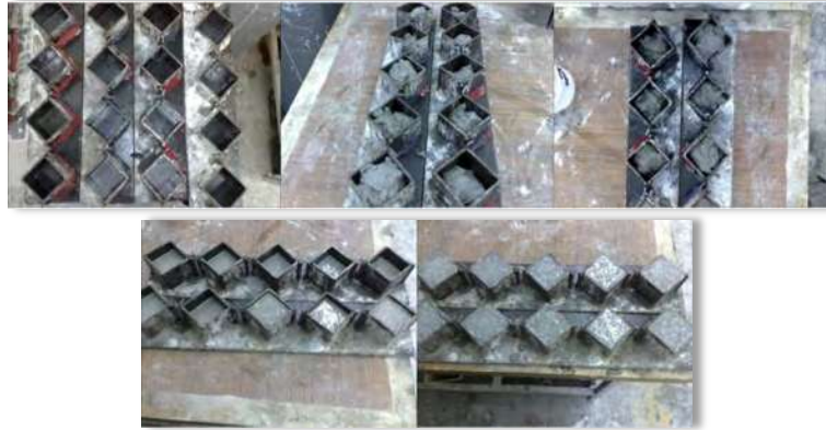
Figura 3.2. 3. Proceso de colocación del concreto en los moldes metálicos de 5x5x5 cm.
