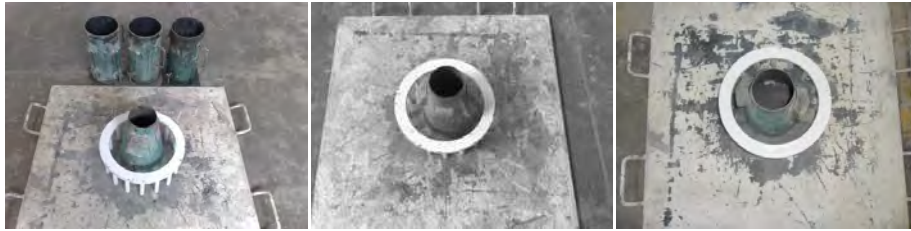
Figura 5.1. 2. Colocación del anillo japonés y del cono de Abrams en la parte central de la placa.
