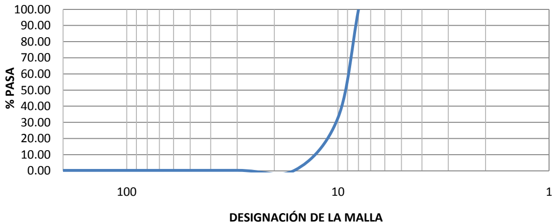
Figura 4.1. 4. Grafica de la granulometría de la marmolina del tipo Grano 1
