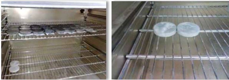
Figura 5.6. 3. Colocación de las pastillas en el horno para su secado.
