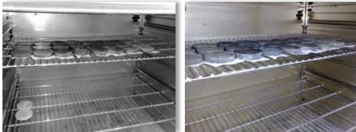
Figura 5.5. 2. Colocación de las muestras en el horno para su secado.
