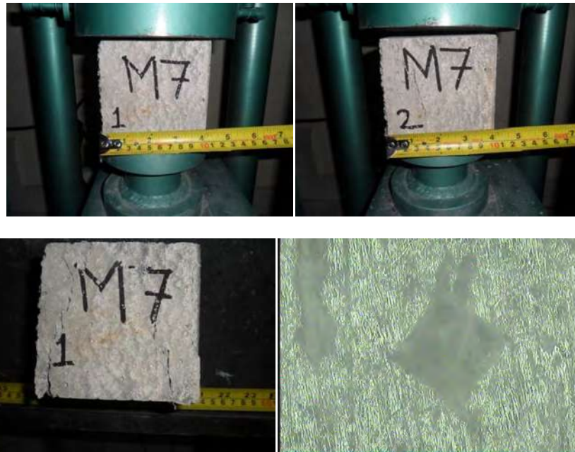
Figura 5.3. 8. Imágenes de la muestra M-7 antes y después del ensayo a compresión
