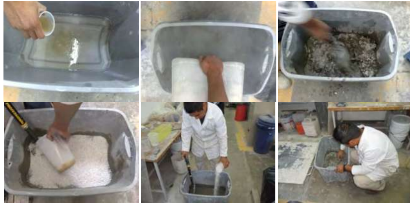
Figura 4.2. 3. Proceso de mezclado de cada agregado
