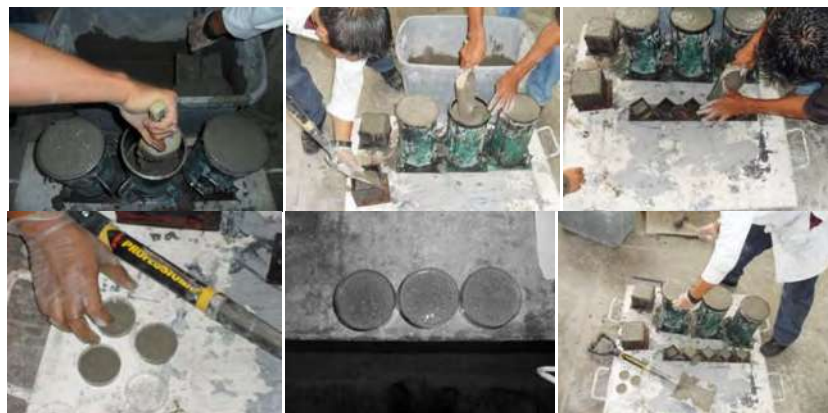
Figura 4.2. 5. Proceso de colado del concreto a los moldes.
