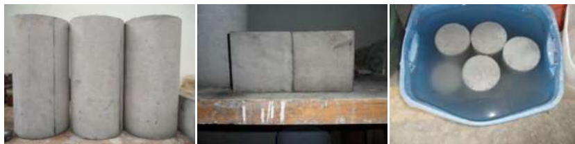
Figura 4.2. 6. Desmoldado y curado de los especímenes.
