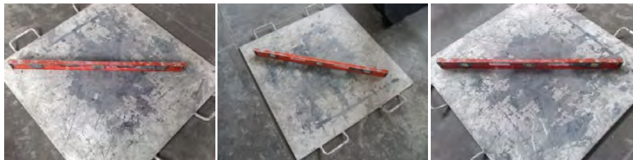
Figura 5.1. 1. Colocación de la placa metálica y su nivelado.
