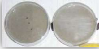
Figura 5.6. 2. Pastillas de cemento hidratado fresco colocado en cajas de petri.
