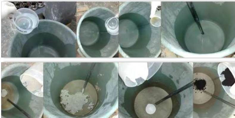
Figura 3.2. 2. Proceso de mezclado de todos los agregados.
