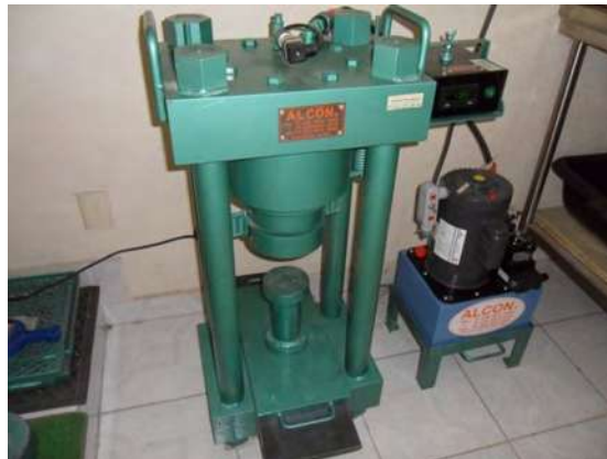
Figura 5.3. 1. Máquina para ensaye a compresión.
