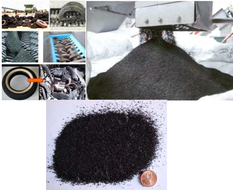
Figura 2.2. 14. Proceso de trituración del neumático usado
