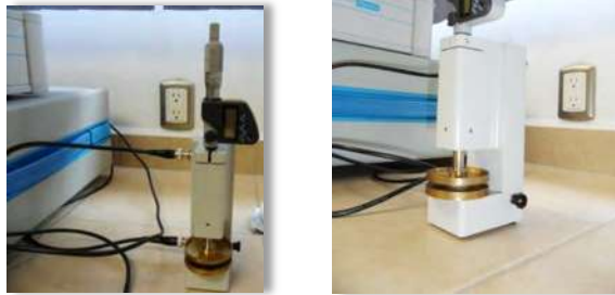
Figura 5.7. 4. Porta muestras modelo 1296-2A para especímenes sólidos
