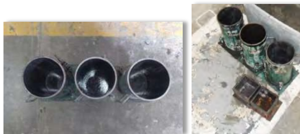
Figura 4.2. 1. Engrasado de los moldes a utilizar
