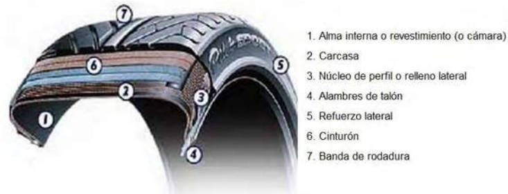
Figura 2.2. 11. Estructura de un neumático, ( http://vehiculosautomoviles.blogspot.com/2010/02/estructura-de-un-neumatico.html .)
