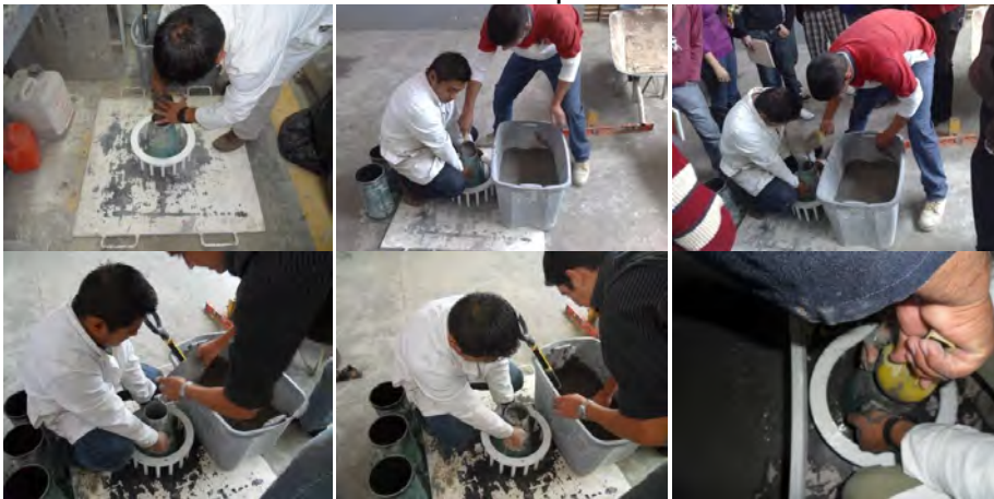
Figura 5.1. 3. Llenado del cono de Abrams.
