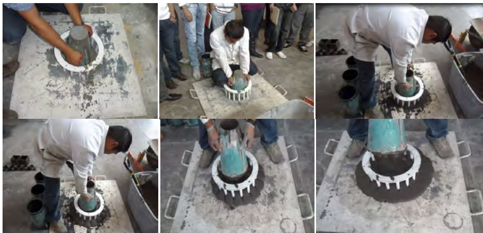
Figura 5.1. 5. Vaciado del cono de Abrams.
