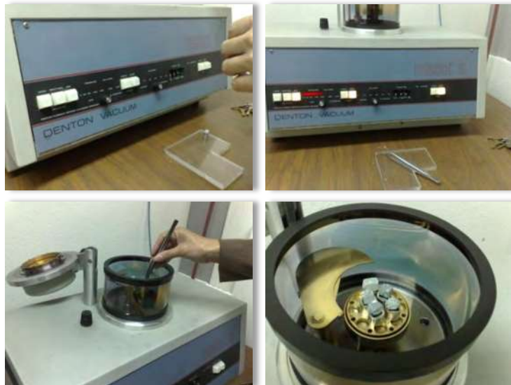
Figura 5.5. 5. Imagen del equipo metalizador DENTON VACUUM modelo DESK II y la colocación de las muestras en el metalizador.
