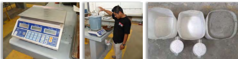
Figura 4.2. 2. Pesado de los agregados a utilizar, dependiendo del tipo de composición
