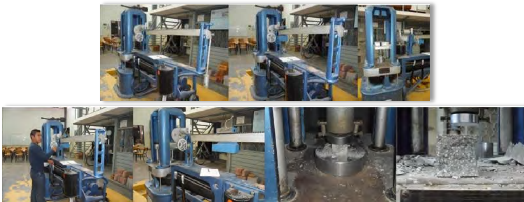
Figura 3.2. 5. Imágenes del proceso de ensaye en un cubo de 5x5x5 en la maquina Tinius Olsen.
