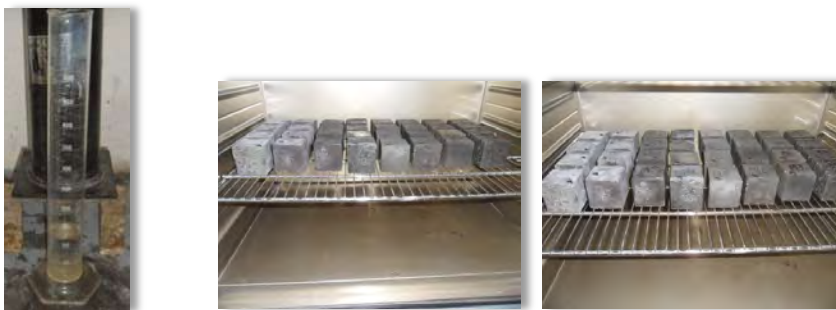
Figura 5.2. 4. Registro de la cantidad de agua desalojada y la colocación de las muestras al horno para su secado.
