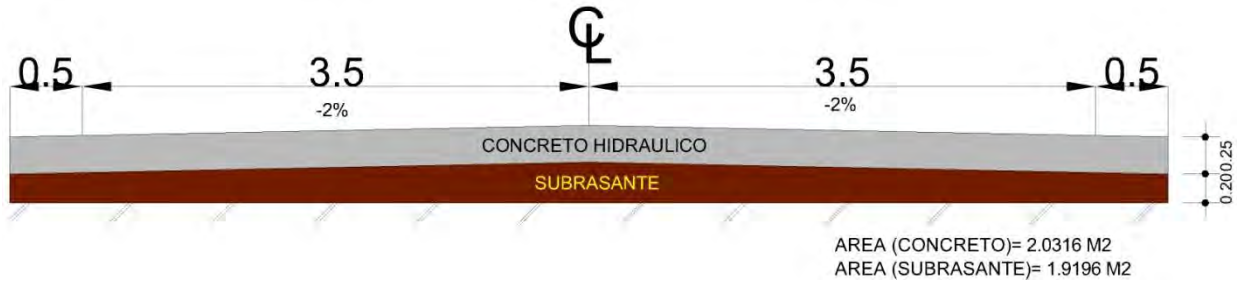
Figura 8.2. 9. Sección calculada para un concreto estándar.
