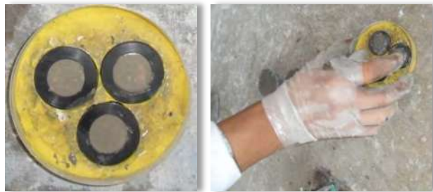
Figura 5.7. 1. Pastillas circulares elaboradas para la caracterización eléctrica.
