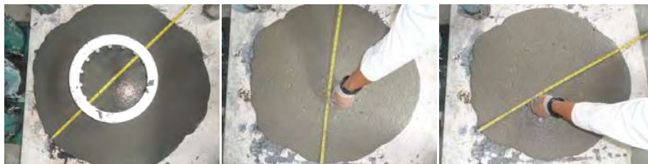
Figura 5.1. 6. Medición de la extensibilidad.
