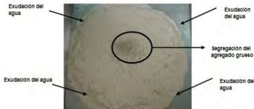
Figura 2.2. 18. Aspecto de un concreto autocompactable donde se ha producido segregación del agregado grueso en el centro y de pérdida de agua en el frente de avance del ensayo, (Fava, Agosto 2003)
