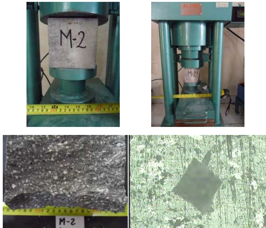
Figura 5.3. 3. Imágenes de la muestra M-2 antes y después del ensayo a compresión
