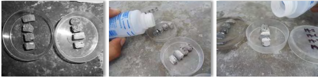
Figura 5.5. 4. Saturación de las muestras en alcohol.
