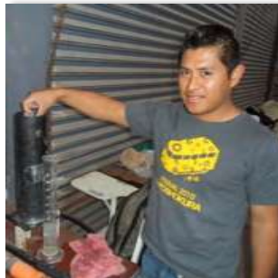
Figura 5.2. 3. Colocación de la muestra en el picnómetro.
