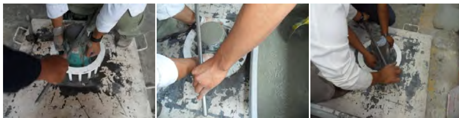
Figura 5.1. 4. Enrasado del concreto con la varilla punta de bala liso.
