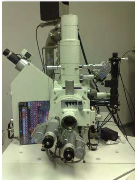
Figura 5.5. 7. Unidad de microanálisis BRUCKER X FLASH-4010, resolución 133eV.
