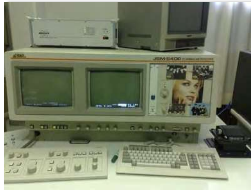
Figura 5.5. 6. Microscopio electrónico de barrido JEOL modelo JSM-6400.
