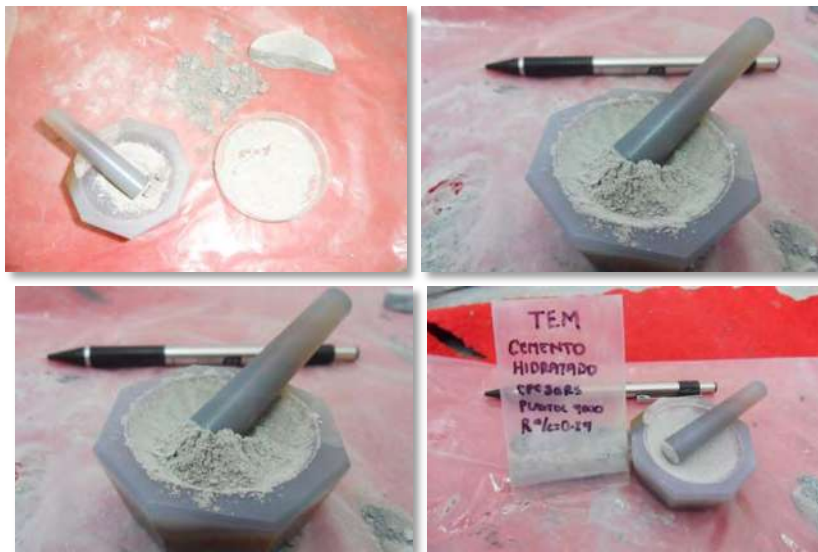
Figura 5.6. 4. Molido del cemento hidratado hasta convertirlo en polvo.
