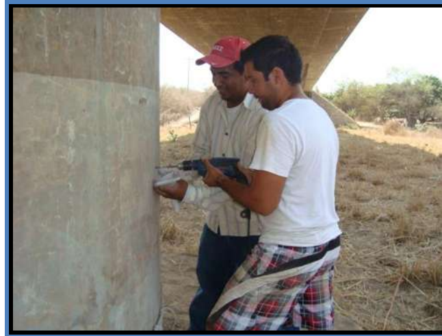
Foto VI.9 Extracción de polvo a 2 y 4 cm.
