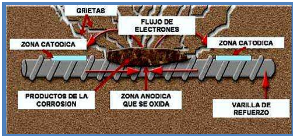
Figura II.1. Celda de corrosión para el concreto reforzado.
