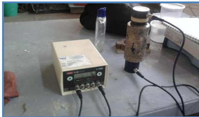
Foto VI.3 Prueba de Pulso Ultrasónico.
