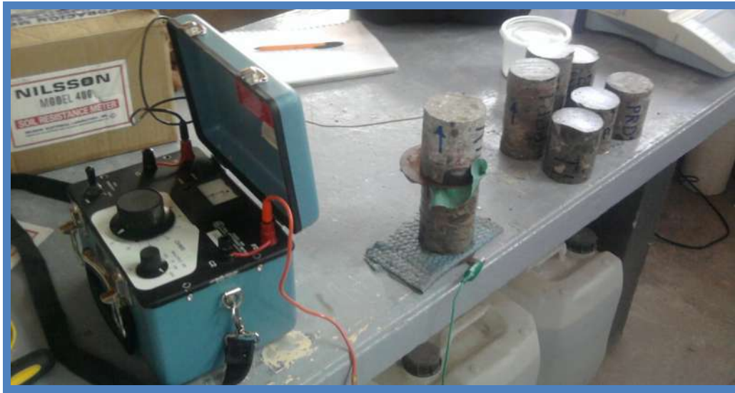
Foto VI.2 Prueba de Resistividad Eléctrica
