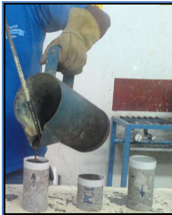
Foto VI.12 Cabeceando los testigos extraídos para realizarles la prueba de compresión simple.
