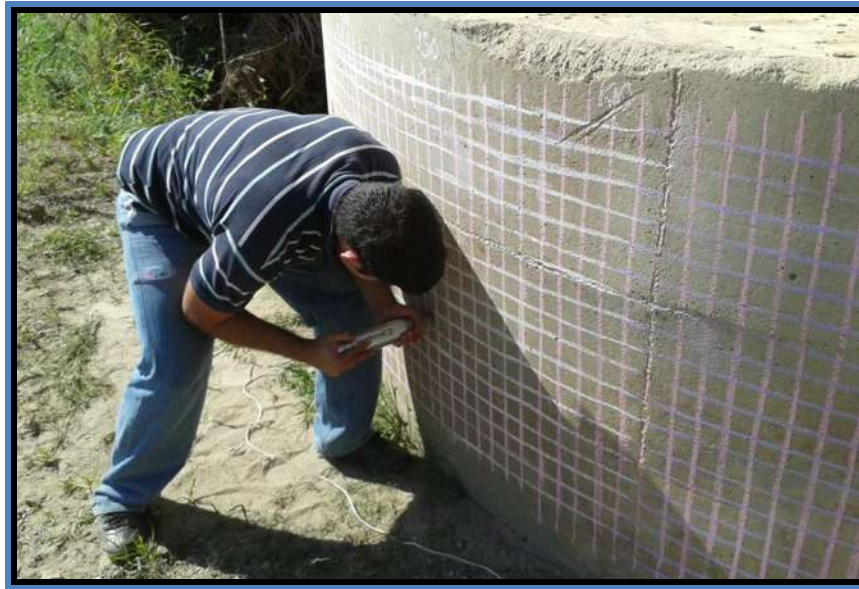
Foto VI.4 Prueba de Esclerometría del Puente “El Cayaco” Lázaro Cárdenas, Michoacán. (18/FEB/2012).
