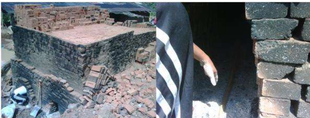
Imagen 3-15. Horno de cocción de tabiques.
