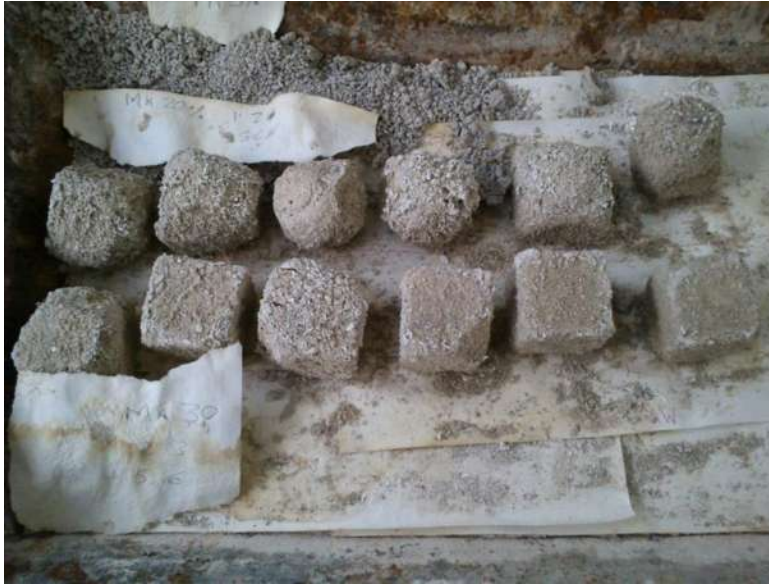
Imagen 5-5. MK 20 y 30% después del quinto ataque por sales de sulfatos de sodio.
