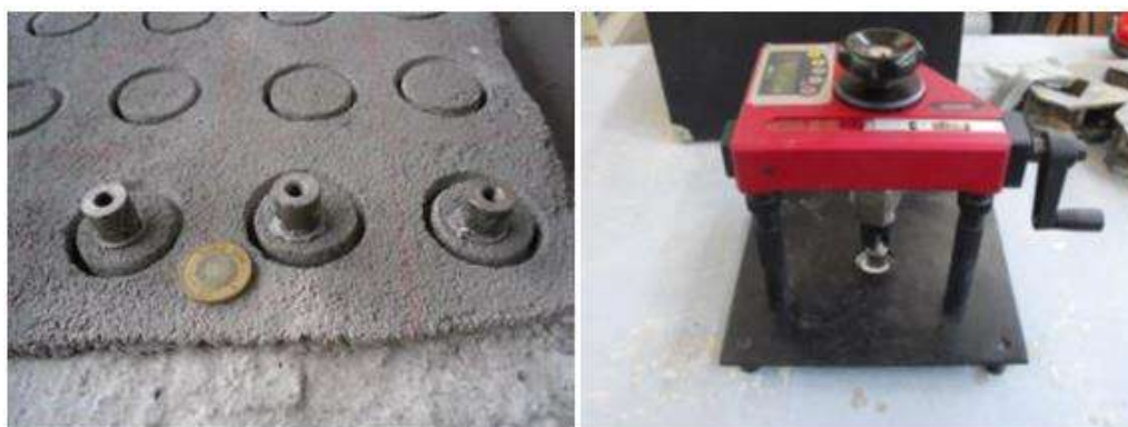
Imagen 4-6. Preparación de prueba de adherencia.
