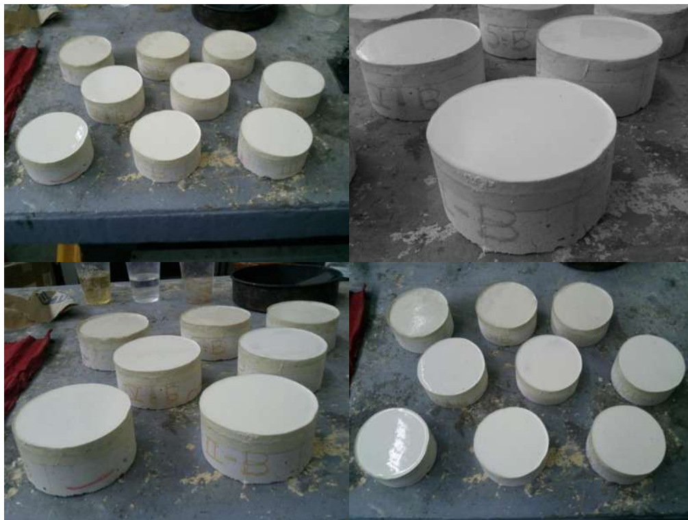
Figura 46. Colocación de recubrimiento en las pastillas de concreto para la prueba de permeabilidad rápida de cloruros.
