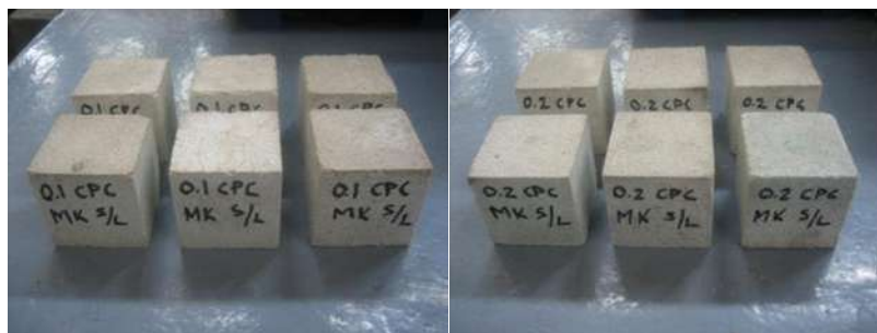
Figura 29. Cubos con sustitución de 10 y 20% sin látex.
