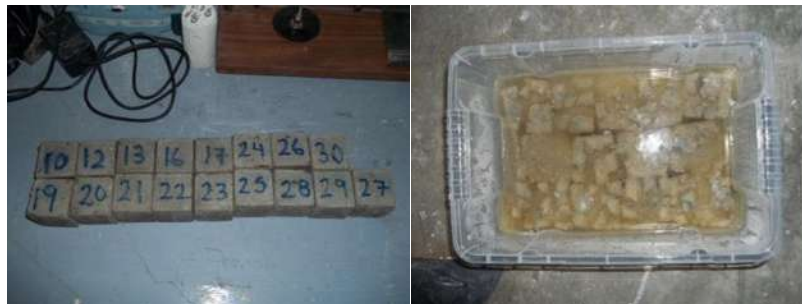
Figura 41. Segundo ciclo de intemperismo acelerado en cubos de cemento con sustitución.
