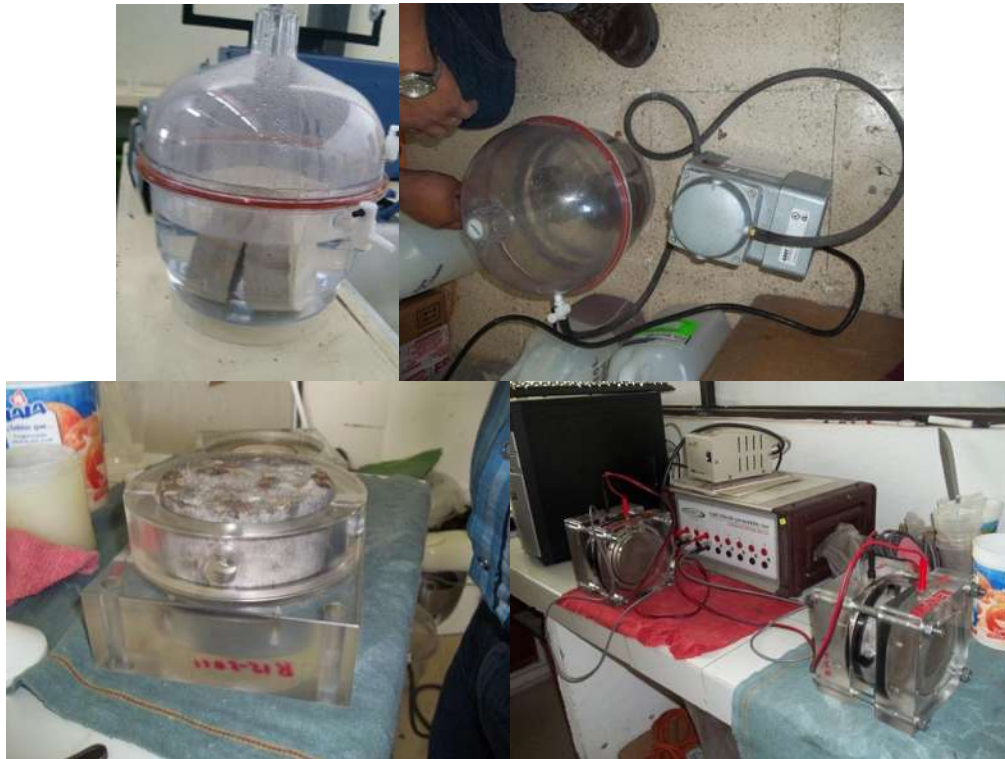
Figura 54. Prueba de permeabilidad rápida de cloruros en pastillas de concreto.
