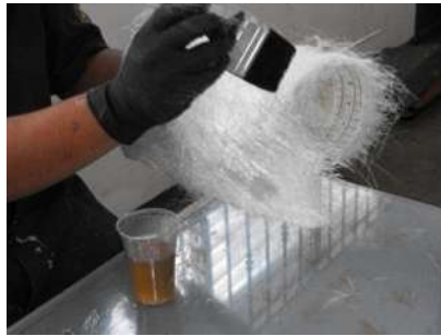
Figura 44. Elaboración de los moldes para recubrir los cilindros de concreto.
