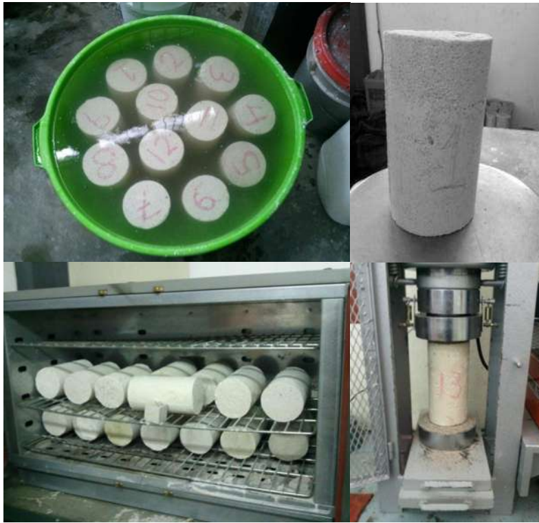
Figura 49. Primer ciclo de intemperismo acelerado en cilindros de concreto recubiertos.
