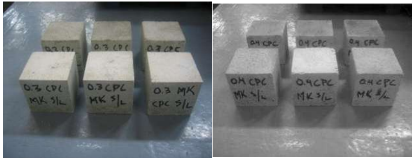
Figura 30. Cubos con sustitución de 30 y 40% sin látex.
