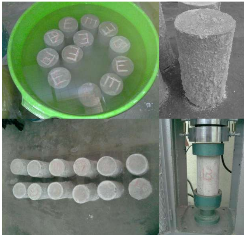
Figura 48. Primer ciclo de intemperismo acelerado en cilindros de concreto testigo.
