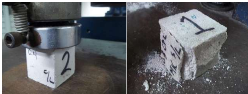
Figura 35. Prueba de resistencia a compresión en cubos.
