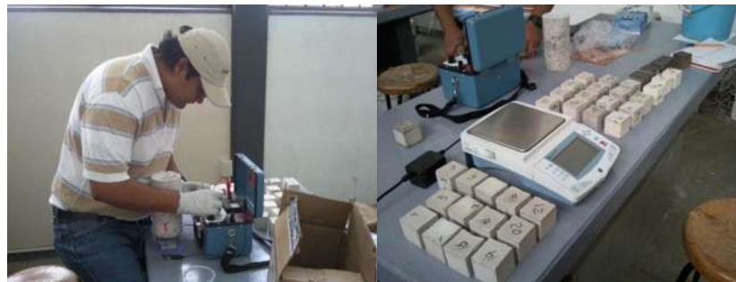
Figura 34. Medición de resistividad eléctrica.
