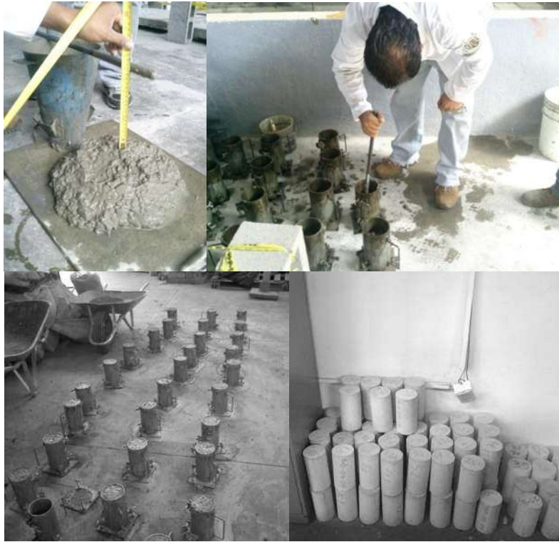
Figura 42. Elaboración de cilindros de concreto.
