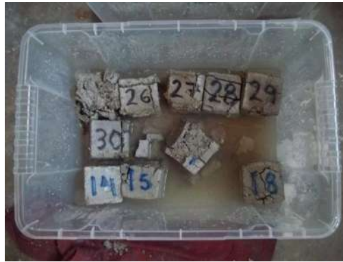
Figura 40. Falla de los cubos de mortero con sustitución después del primer ciclo de intemperismo acelerado.
