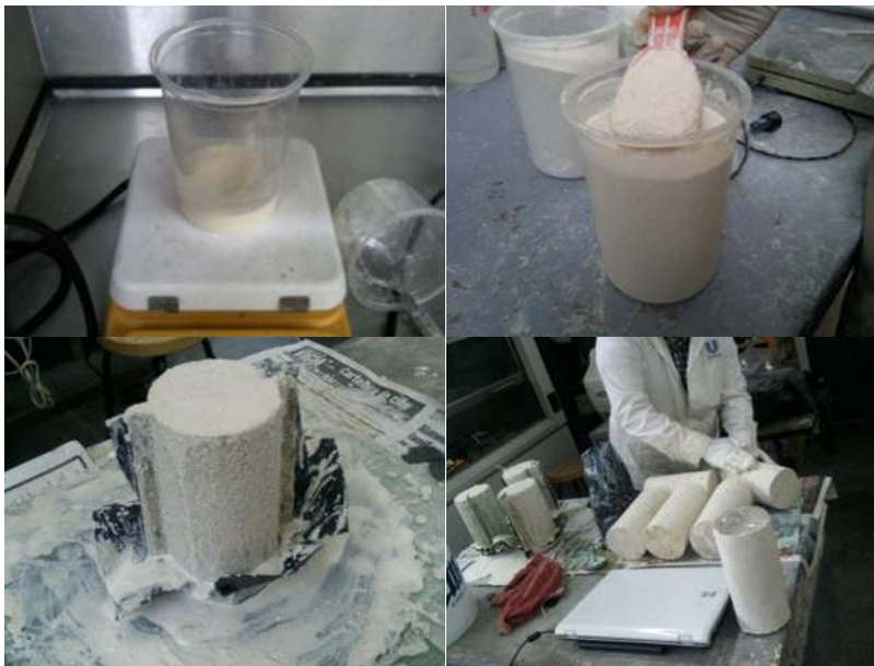
Figura 45. Colocación del recubrimiento en los cilindros de concreto.
