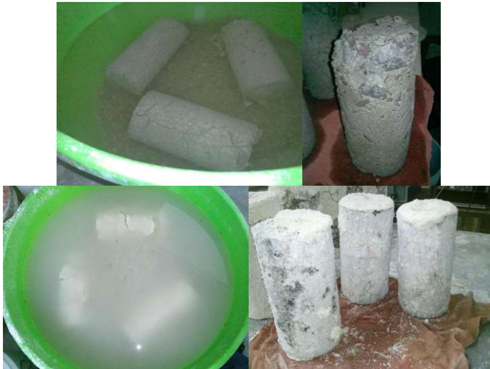
Figura 53. Quinto ciclo de intemperismo acelerado en cilindros de concreto.
