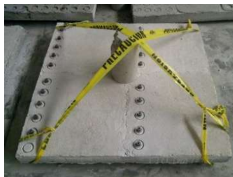
Figura 43. Losa con recubrimientos.
