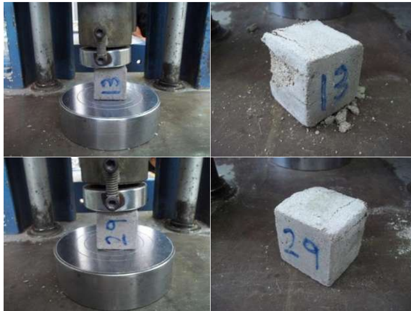
Figura 39. Resistencia a la compresión en cubos de mortero con sustitución.
