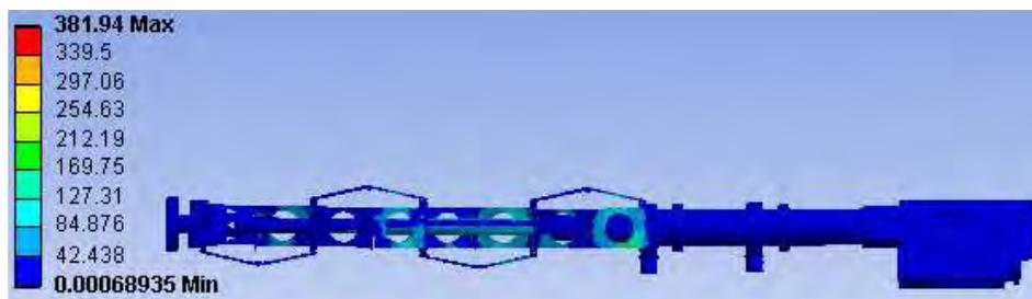
Figura 7.29. Esfuerzos a los que se encuentran sometidos elementos que componen al pie.
