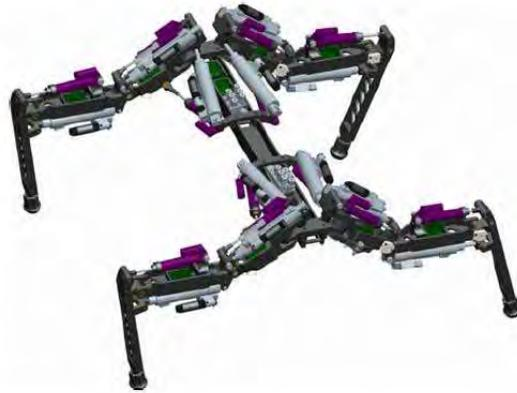
**Figura 1.14.** Robot cuadrúpedo hidráulico.[40]
