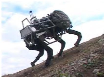
**Figura 1.13.** Robot cuadrúpedo hidráulico. [38]
