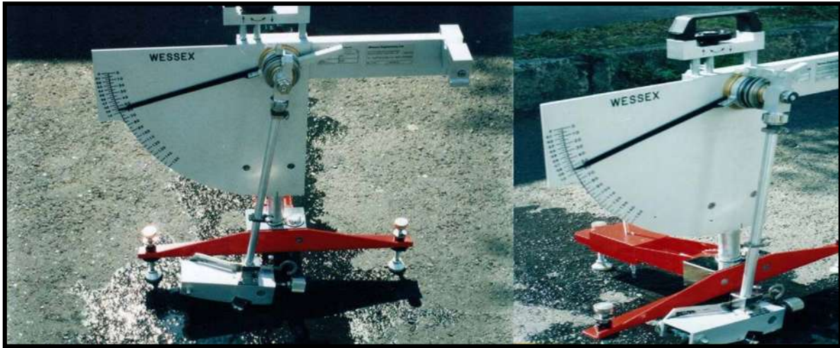
Figura 2.7. Péndulo Ingles para coeficiente de fricción.
