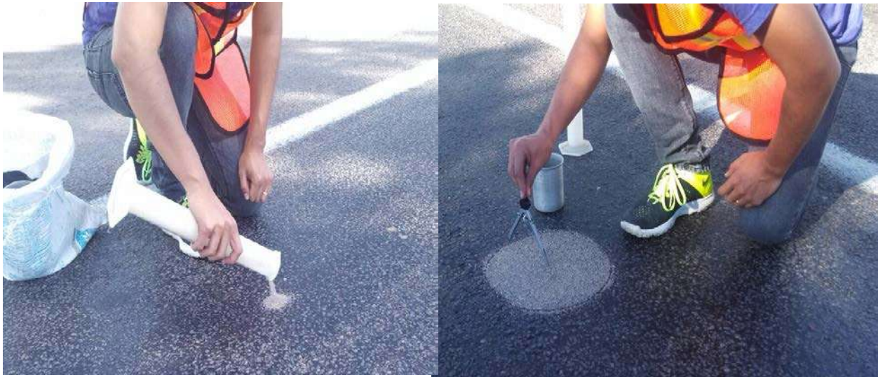
Figura 3.5. Ensayo de círculo de arena sobre pavimento (prueba con un volumen de 50 cm 3 de arena).
