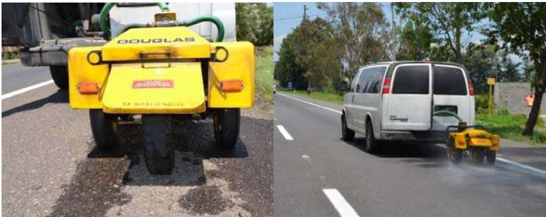
Figura 3.6. Equipo de medida de fricción Mu-Meter en operación sobre carreteras Michoacanas.
