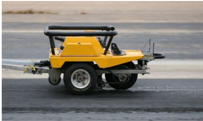
Figura 2.9. Griptester español operando en la auscultación de redes.
