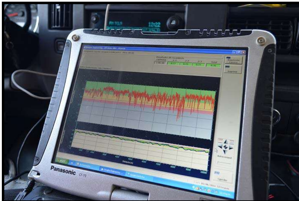
Figura 2.12. Grafica de los valores de fricción obtenidos en un tramo por el Mu-Meter.
