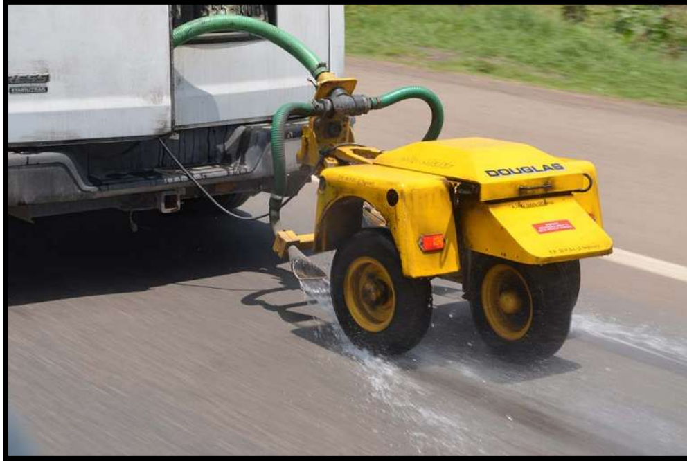
Figura 2.13. Mu-Meter en operación en la red mexicana de carreteras.
