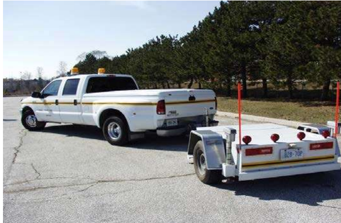
Figura 2.8. ASTM E-274 Tester estadounidense para ensayo con rueda bloqueada.
