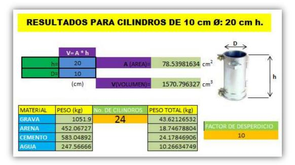
Figura 9. Calculo de los materiales para un número conocido de cilindros con ayuda de la hoja de cálculo (Propia del autor).
