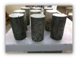
Figura 50. Especímenes cilíndricos de las diferentes mezclas de concreto después de 4 ciclos de inmersión en la solución de sulfato. (Propia del autor)
