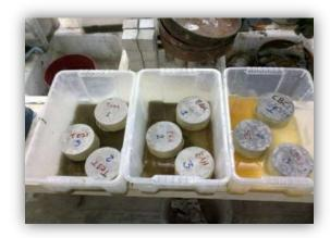
Figura 25. Realización del ensayo de absorción capilar. (Propia del autor)
