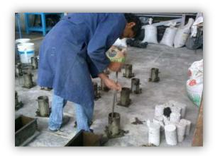
Figura 12. Llenado de los espécimenes cilíndricos de la mezcla Testigo. (Propia del autor)
