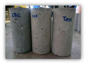
Figura 51. Especímenes cilíndricos de las diferentes mezclas, después de 15 ciclos repetidos de congelamiento y deshielo. (Propia del autor)
