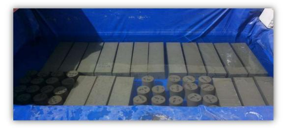
Figura 14. Curado de los espécimenes de concreto elaborados con las diferentes mezclas de concreto, con y sin sustitución. (Propia del autor)
