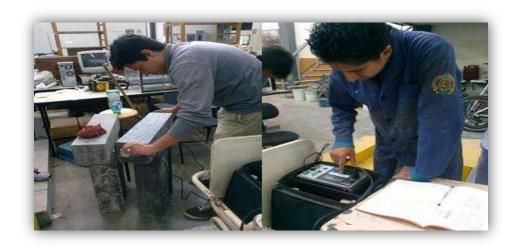
Figura 16. Medición de la velocidad de pulso ultrasónico en espécimen prismático de mezcla CBC. (Propia del autor)
