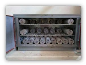
Figura 22. Secado de los espécimenes hasta peso constante. (Propia del autor)
