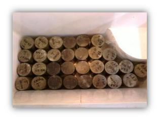
Figura 23. Especímenes cilíndricos de concreto de las diferentes mezclas, dentro del congelador (primer ciclo). (Propia del autor)
