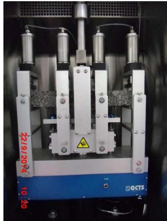
Figura XX.- Equipo para ensayo de viga sujeta a flexión con cámara ambiental sistema de control y adquisición de datos.
