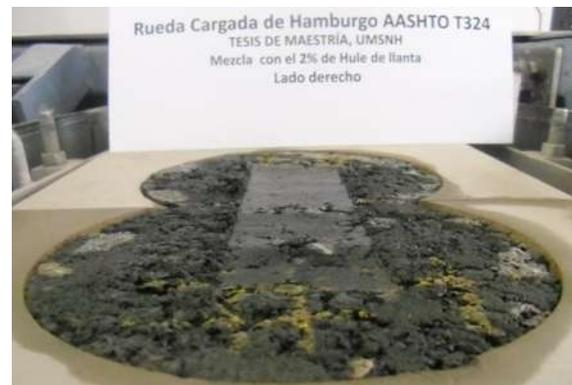
Figura LI.- Especímenes de Hamburgo deformados, con 2% de hule, método A.
