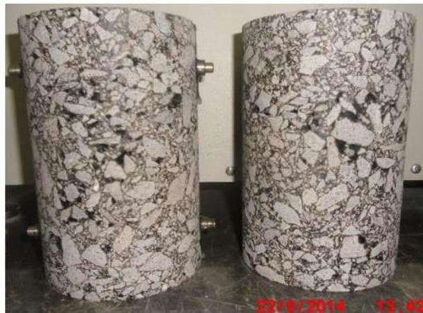
Figura XIX.- Especímenes para ensayo de modulo dinámico.
