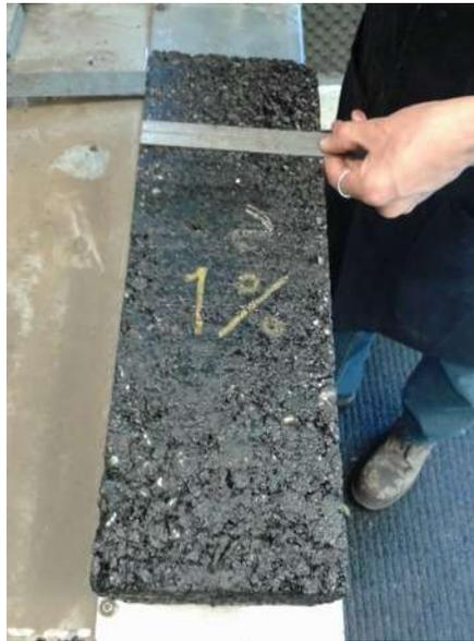
Figura LXIII.- Espécimen compactado en Compactador lineal.
