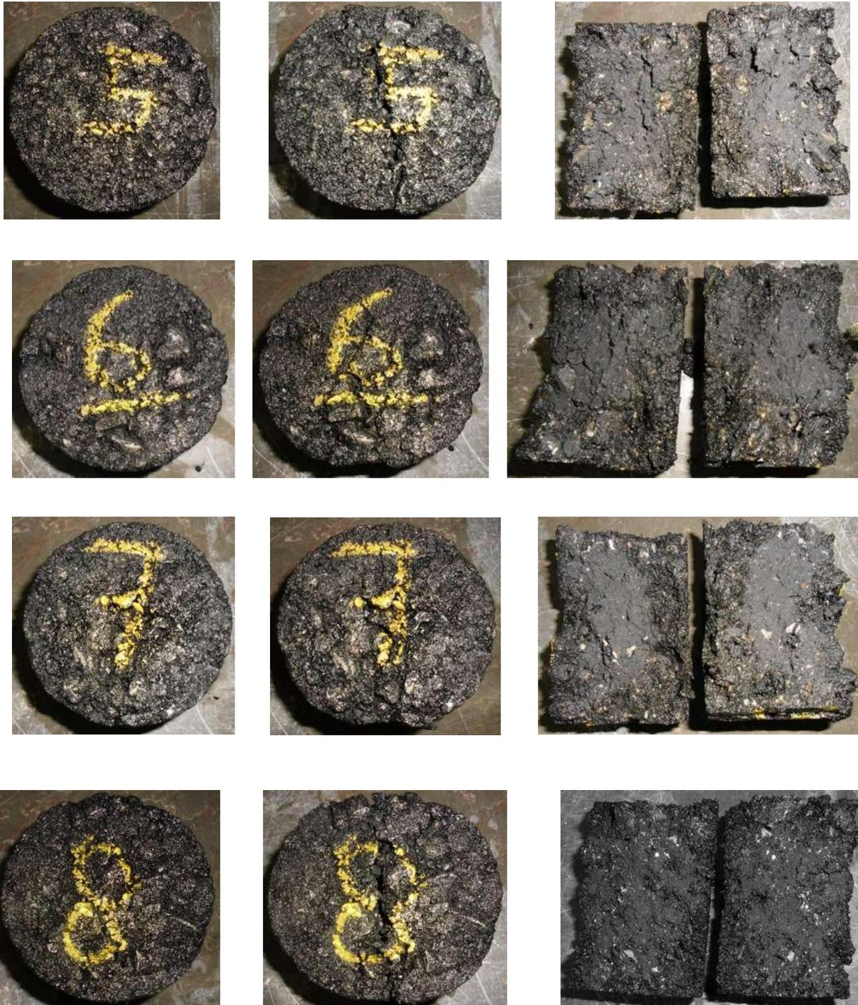
Figura XLIV.- Especímenes acondicionados para TSR, 2% de hule, método B.
