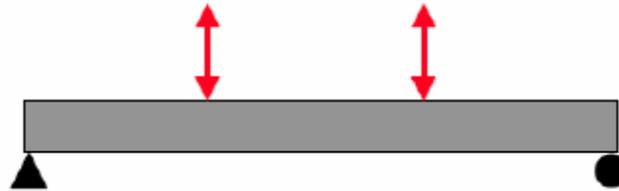
*Figura XXI.- Asignación de la tensión en la muestra del ensayo de flexión a 4 puntos.*
