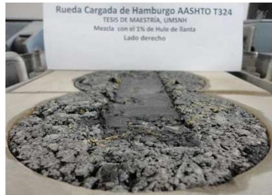
Figura XLIX.- Especímenes de Hamburgo deformados, con 1% de hule, método A.
