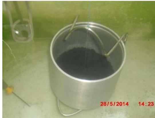
*Figura XXXII.- Picnómetro, material y agua, para determinación de Gmm.*
