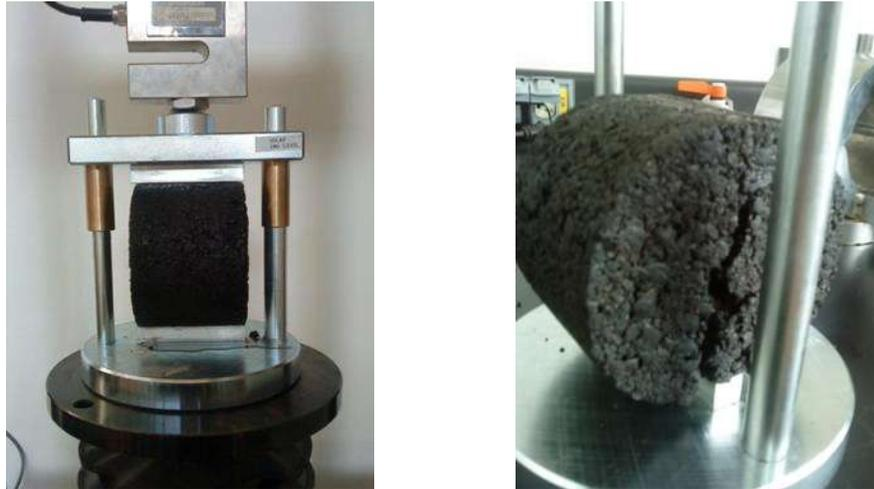
*Figura XVII.- Espécimen montado sobre mordaza Lottman, y espécimen después del ensayo.*
