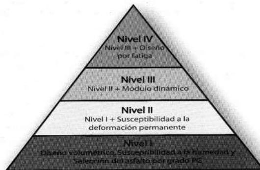
Figura XIV.- Criterios de selección de ensayos para la evaluación del diseño para mezclas asfálticas.
