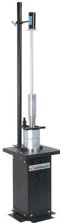
Figura VIII.- Compactador Marshall (Fuente [16]).
