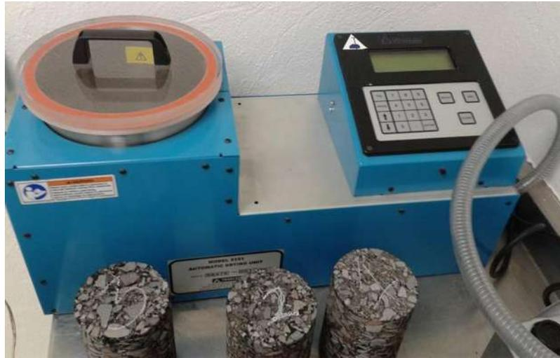
Figura LIX.- Equipo para secado de Especímenes de Modulo Dinámico.
