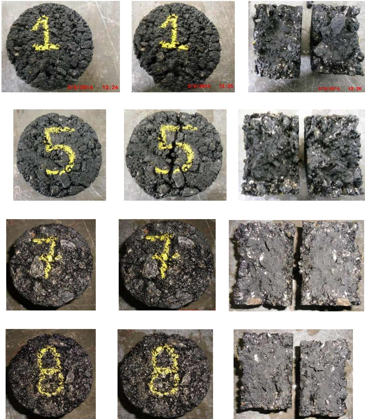
Figura XLI.- Especímenes no acondicionados para TSR, 1% de hule, método B.
