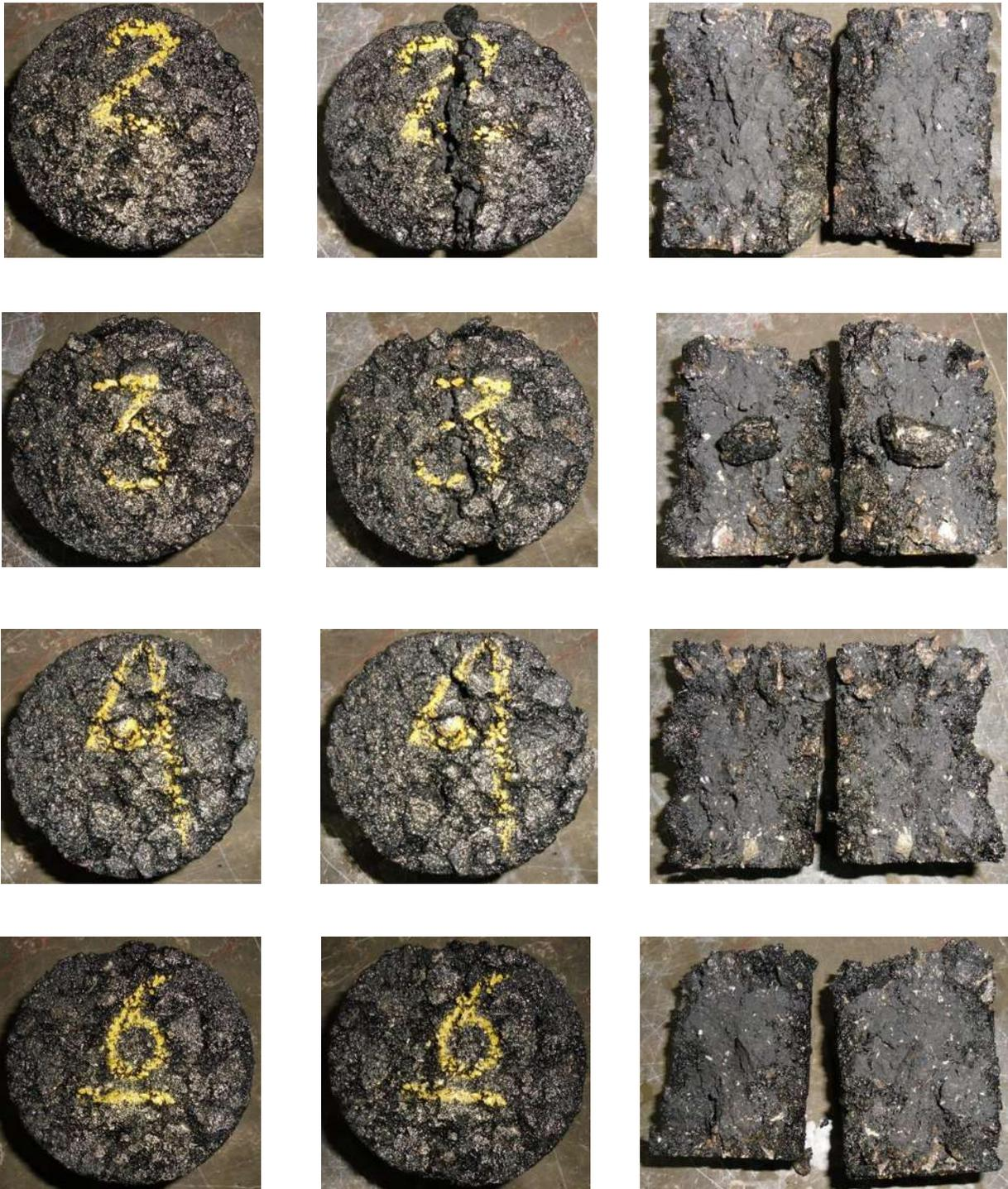
Figura XLII.- Especímenes acondicionados para TSR, 1% de hule, método B.
