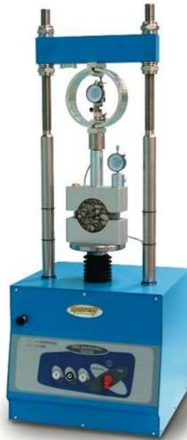
Figura VII.- Prensa para prueba Marshall (Fuente [15]).
