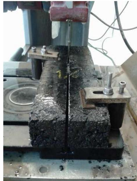
*Figura LXII.- Equipo de corte para vigas.*
