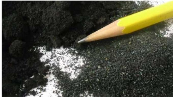
*Figura XXIII.- Comparativa entre hule quemado y hule nuevo de llanta con SBR.*
