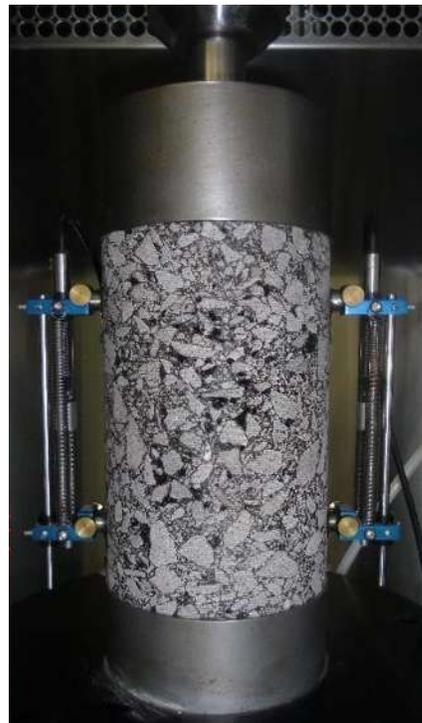
*Figura LVI.- Especimen para módulo montado para ensaye.*
