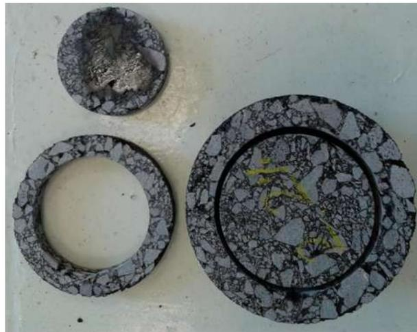
Figura LX.- Núcleo para Modulo Dinámico después de ser cortado.
