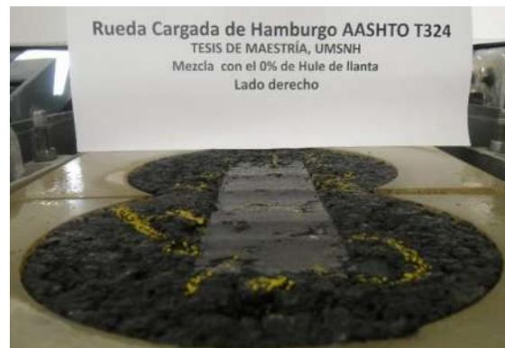
Figura XLVII.- Especímenes de Hamburgo deformados, con 0% de hule, método A.
