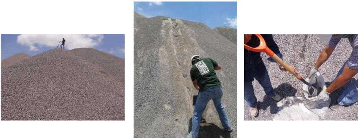
*Figura XXVII.- Proceso de muestreo en banco de material.*
