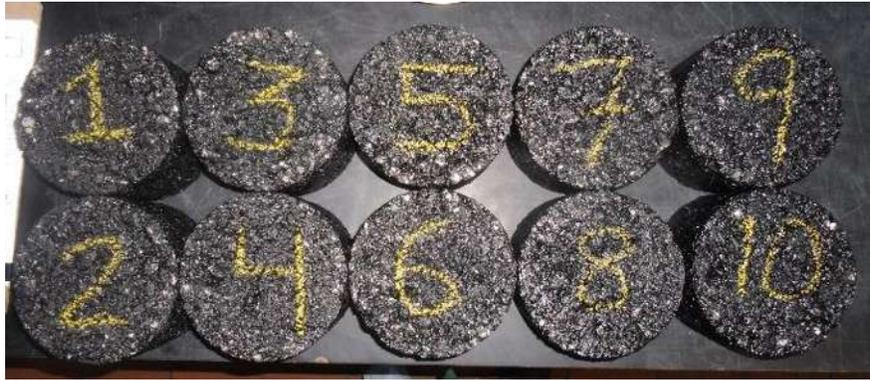
*Figura XXXIII.- Especímenes con diferentes contenidos de asfalto.*
