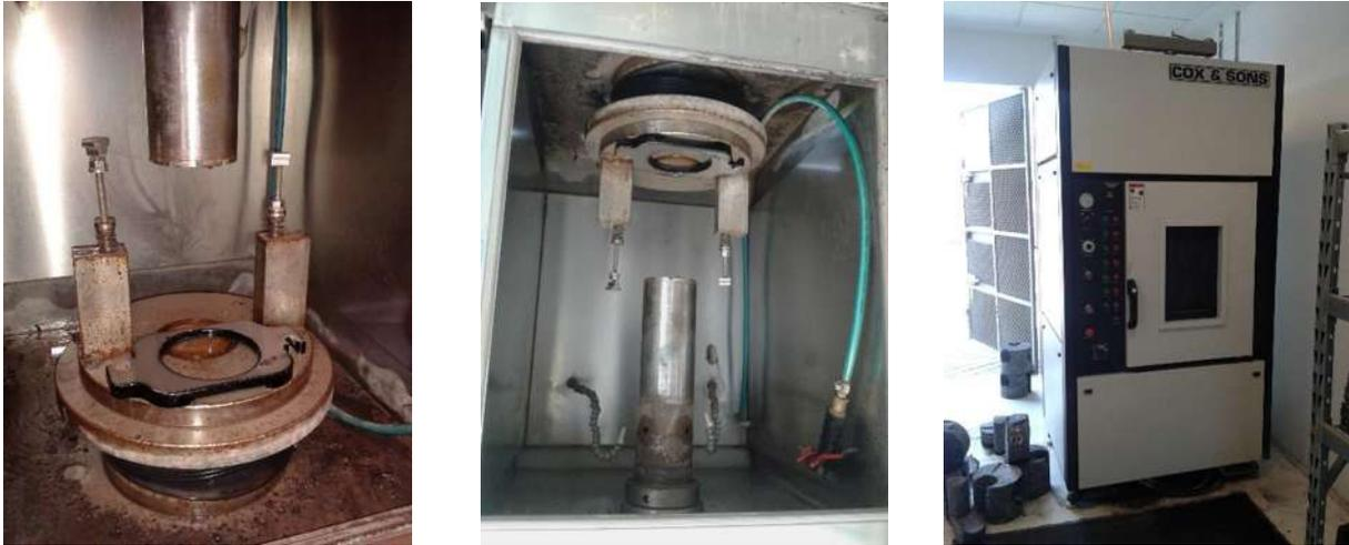
Figura LVII.- Equipo para extracción de núcleos para Modulo Dinámico.
