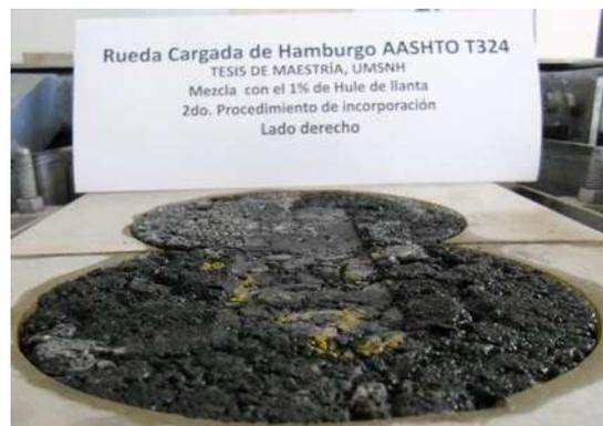
Figura LIII.- Especímenes de Hamburgo deformados, con 1% de hule, método B.
