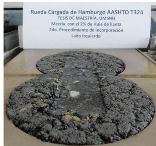
Figura LV.- Especímenes de Hamburgo deformados, con 2% de hule, método B.
