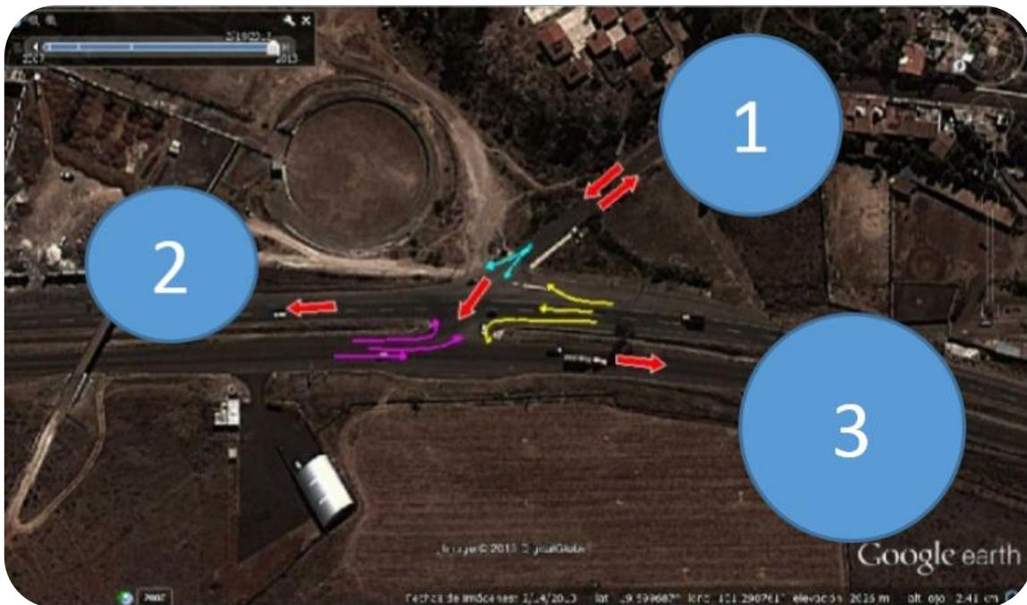
*Figura 4.46 Diagrama de movimientos para el aforo vehicular. Fuente: propia.*
