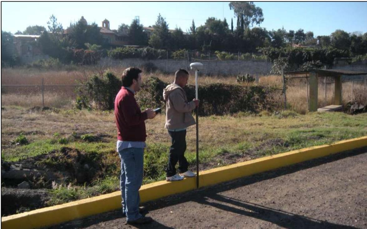
*Figura 4.18 Levantamiento de planimetría con equipo GPS. Fuente: propia.*
