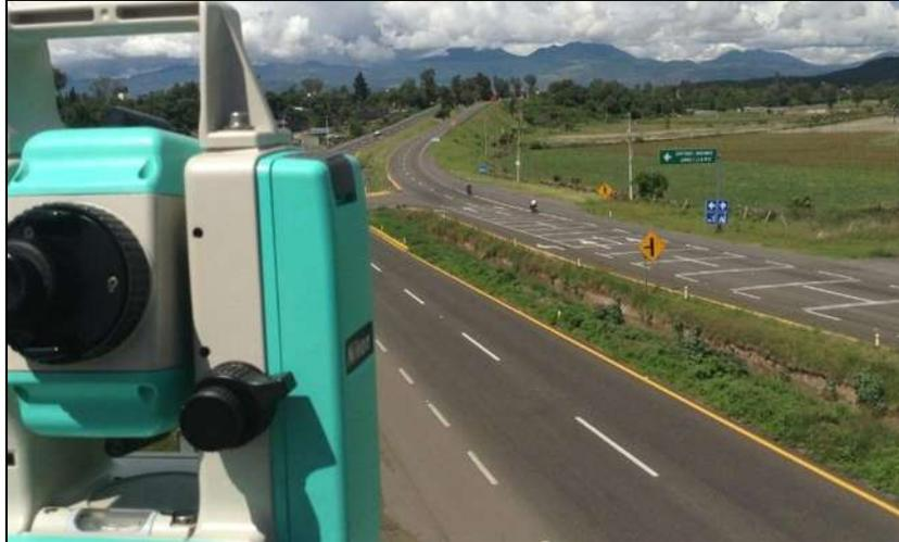
*Figura 4.31 Levantamiento topográfico con estación total (6). Fuente: propia.*
