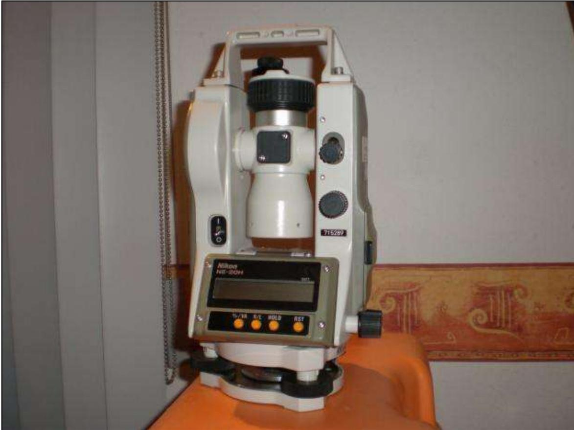
*Figura 3.20 Teodolito electrónico. Fuente: <http://iztapalapa.olx.com.mx/teodolito-nikon-ne-20h-y-nivel-topografico-leica-na720-iid-51872221>*
