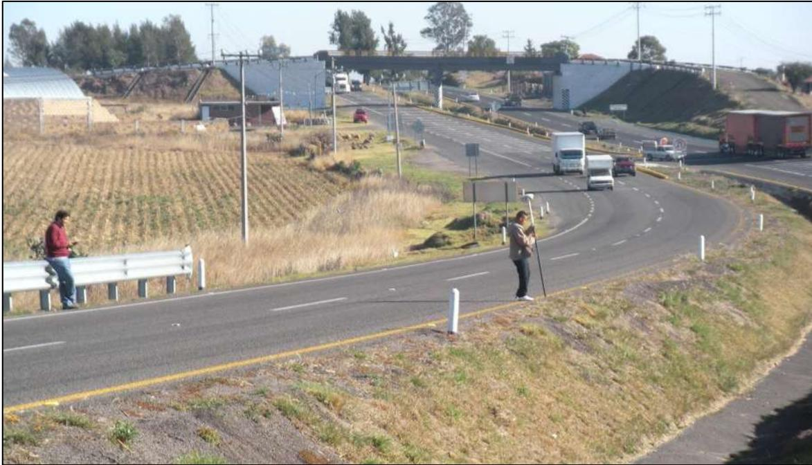
*Figura 4.19 Levantamiento de planimetría con equipo GPS (2). Fuente: propia.*
