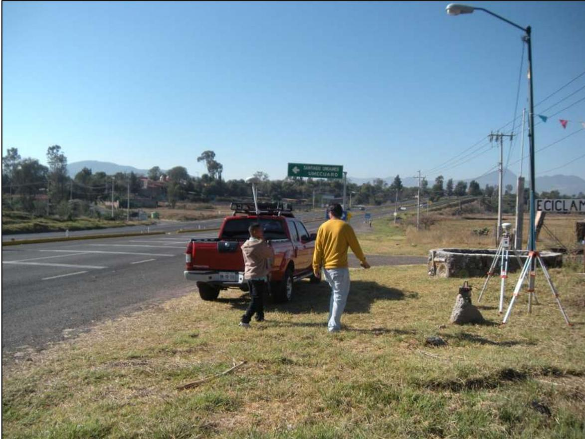
*Figura 3.22 Uso del GNSS para levantamiento topográfico. Fuente: propia.*
