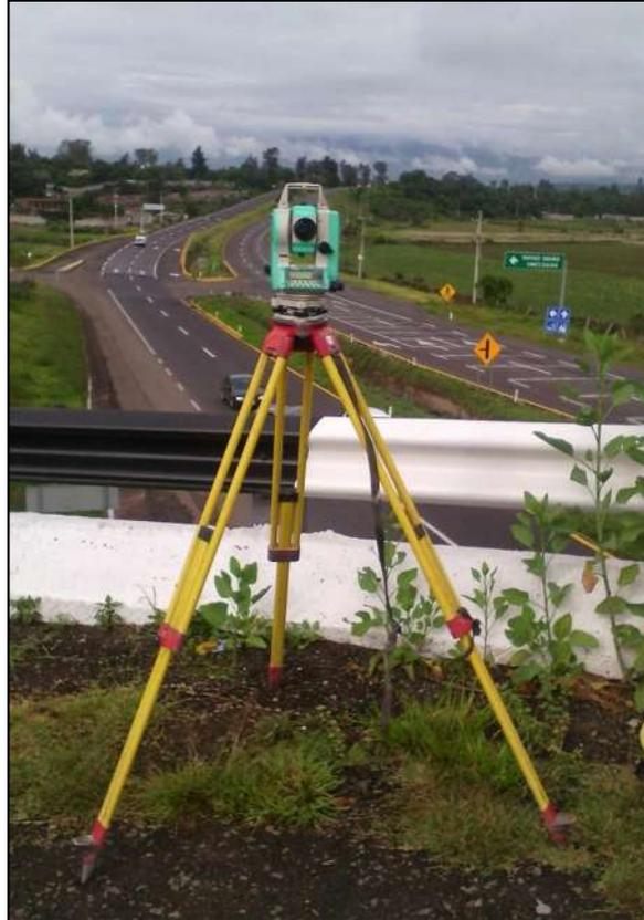
*Figura 4.26 Levantamiento topográfico con estación total. Fuente: propia.*
