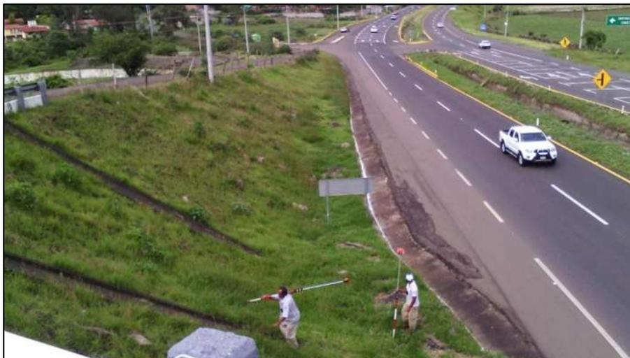
*Figura 4.27 Levantamiento topográfico con estación total (2). Fuente: propia.*
