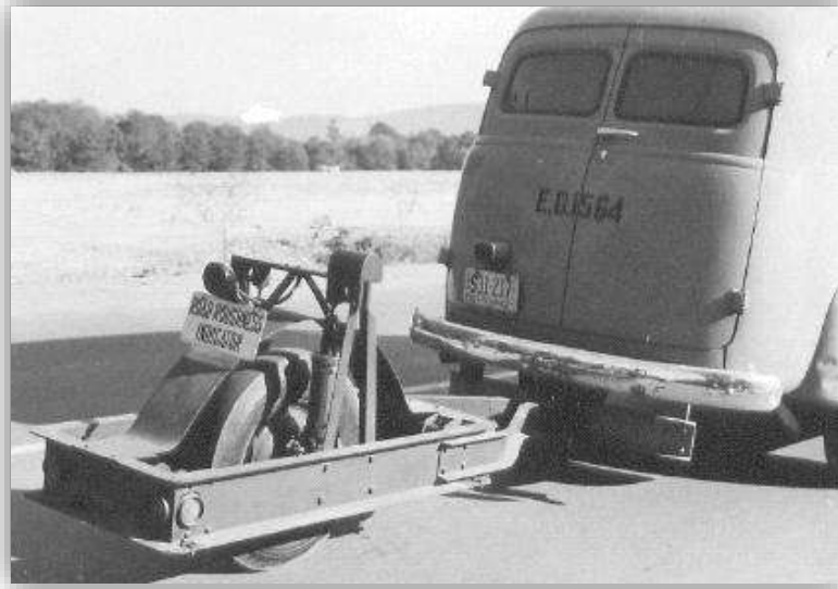
Figura 1.7. Rugosímetro del Departamento Público de Carreteras (BPR).
