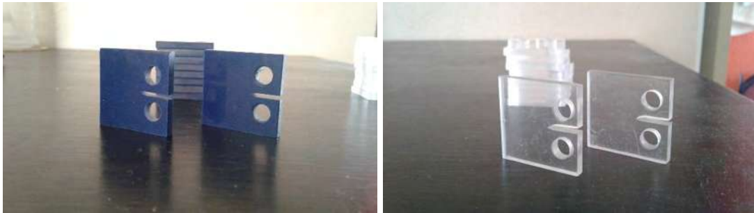
Figura 4. 19. Probetas empleadas para ensayos de fatiga convencional y crecimiento de fisura.
