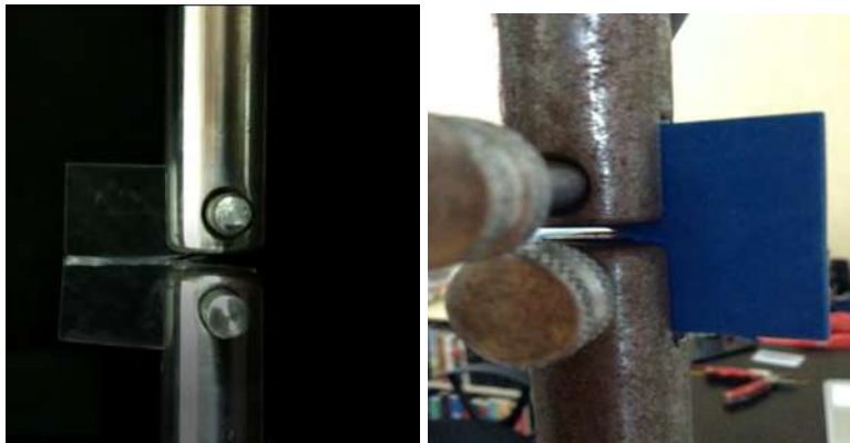
Figura 4. 20. Comportamiento preliminar de aparición y propagación de fisuras.
