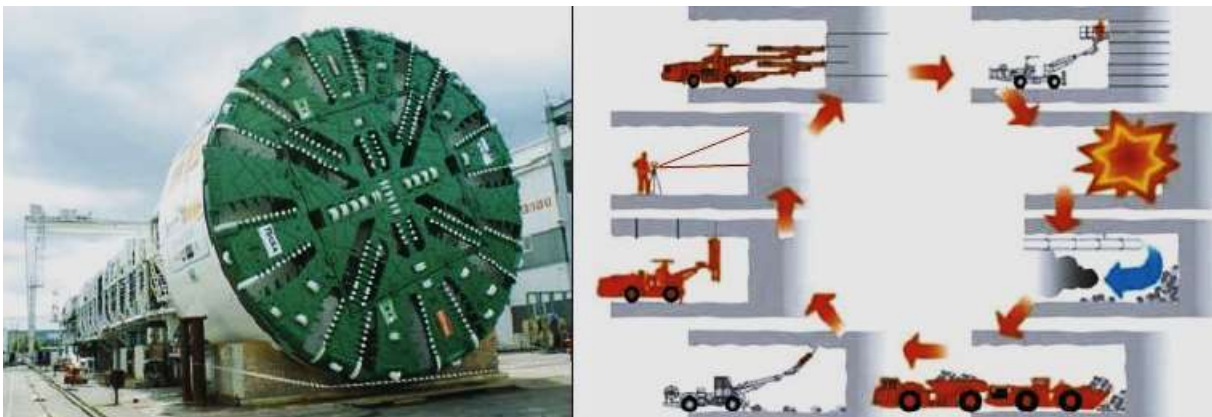
Figura 4.2 Máquina tuneladora EPB y secuencia del proceso constructivo mediante la técnica de perforación y voladura.
