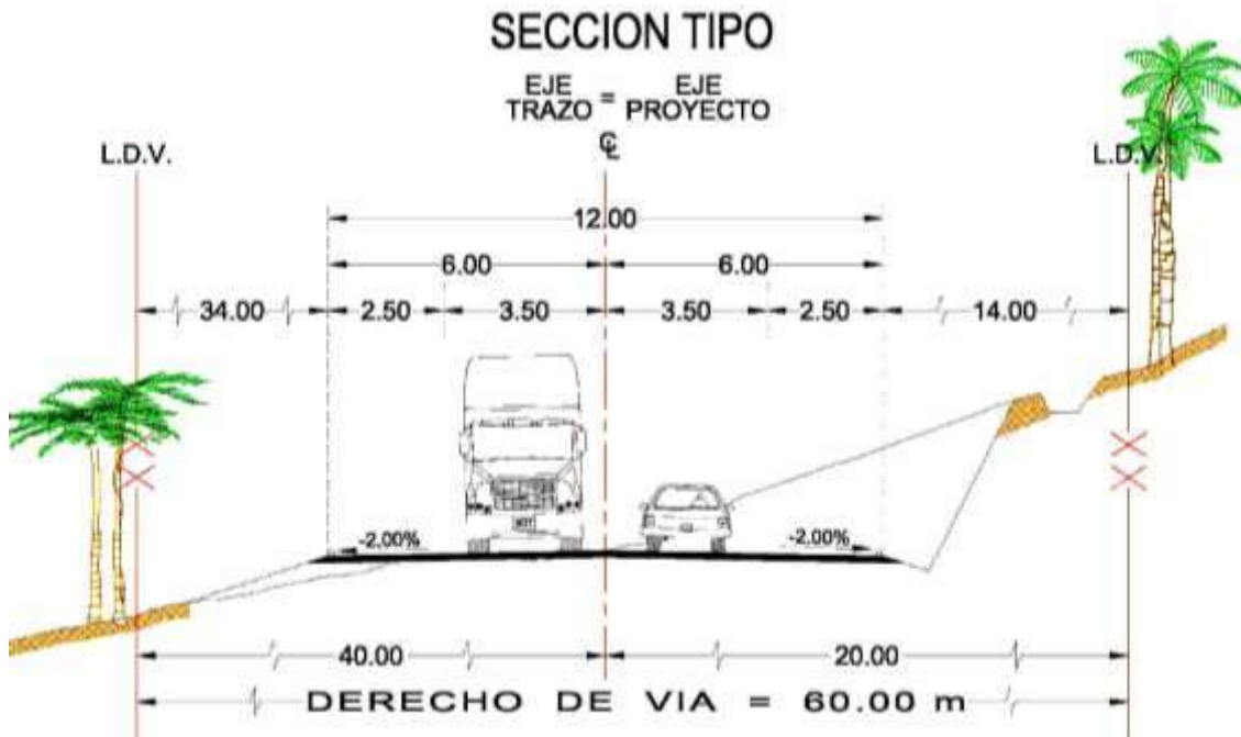
Figura 4.4 Sección transversal de construcción de Carreteras.
