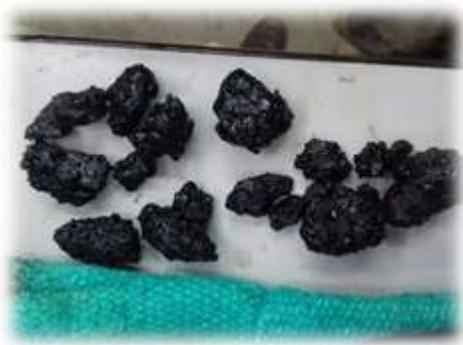
Imagen 17.- Observación de la mezcla después del proceso de desprendimiento
