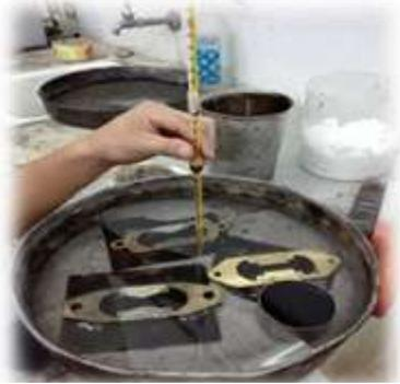
Imagen 2.- Colocación de las muestras a 25°C
