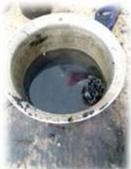
**Imagen 16.- Mezcla con agregado pétreo 20% de RCD en ebullición**
