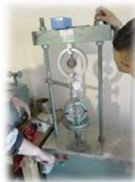
**Imagen 13.- Prueba en la prensa Marshall.**
