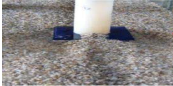
Figura 2.27 Socavación alrededor de la pila con collar cuadrado. Mohammadnezhad, A. (2014).
