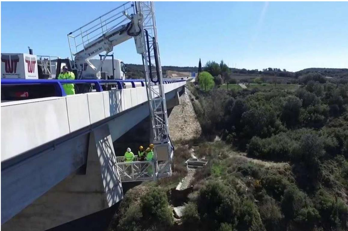
*Figura 3.2 Plataforma para inspección de puentes*
