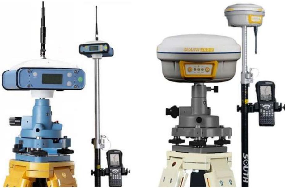
*Figura 1.2 Equipo GPS utilizado para la georreferenciación de los puentes.*
