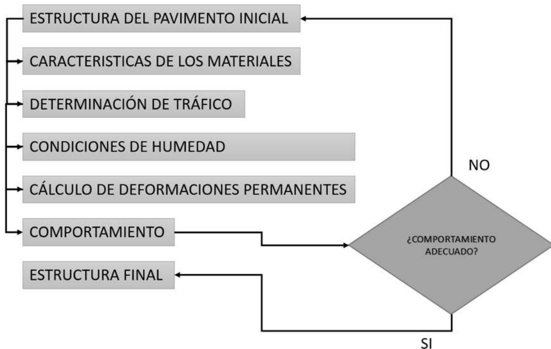
Figura 48 Diagrama general de la determinación de deformaciones permanentes
