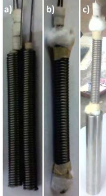
Figura 3.6.- a) mejora en la calidad del embobinado, b) aislamiento eléctrico solo en los extremos de la bobina, c) funda con resistencia aislada.
