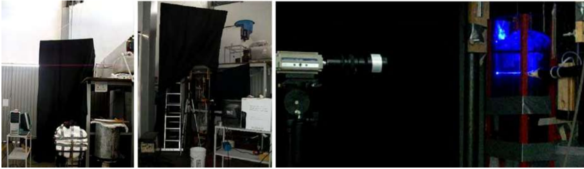
Figura 3.18.- Domo negro construido alrededor del sistema experimental mostrado en la Figura 3.1.
