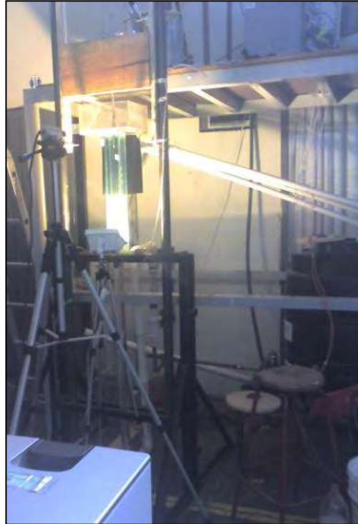
Figura 3.11.- Sistema con iluminación de la cámara de 300 Watts.
