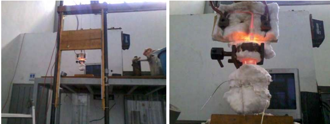
Figura 3.10.- Pruebas de calentamiento de la probeta en el sistema.
