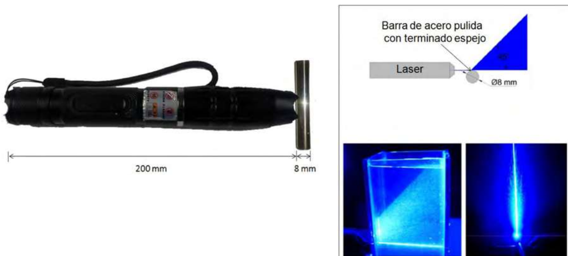
Figura 3.16.- Formación del plano laser.
