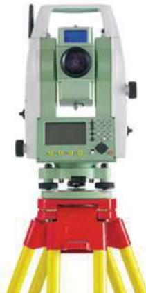
Imagen 3. Estación total utilizada para este proyecto, marca LEICA.
