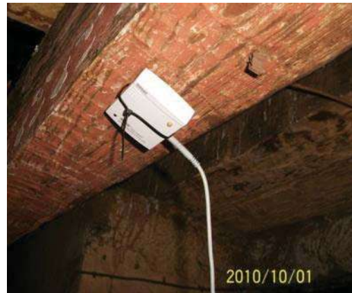
IMAGENES 59 y 60.- Montaje del hobo en la parte del coro y la extensión para la toma de datos de la temperatura exterior.
