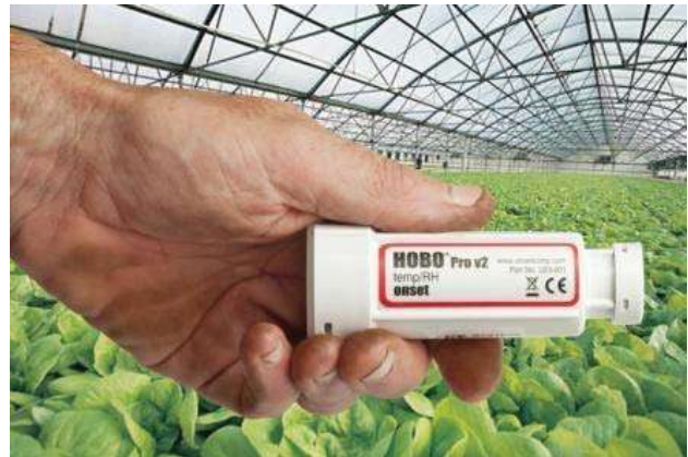
IMAGEN 56 .- Las mediciones se realizan con los datalogers, también denominados Hobos, es un instrumento electrónico capaz de medir temperatura, humedad e intensidad luminosa
