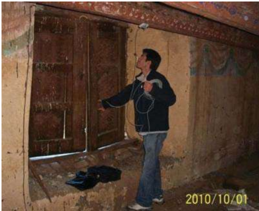
IMAGENES 59 y 60.- Montaje del hobo en la parte del coro y la extensión para la toma de datos de la temperatura exterior.
