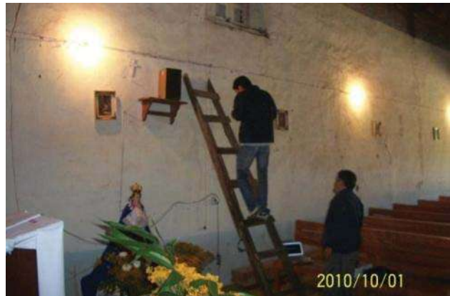
IMÁGENES 57 Y 58 .- Se aprecia el montaje de los hobos en el área correspondiente a la nave principal en los muros norte y sur respectivamente (Foto: J.A.P.I, octubre 2010)
