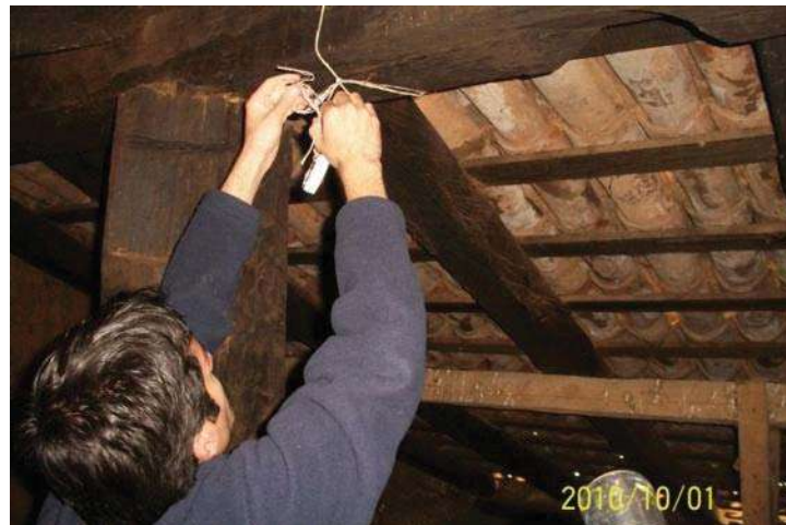
IMAGEN 61 .- La imagen muestra la colocación del aparato en el caballete de la estructura de la cubierta
