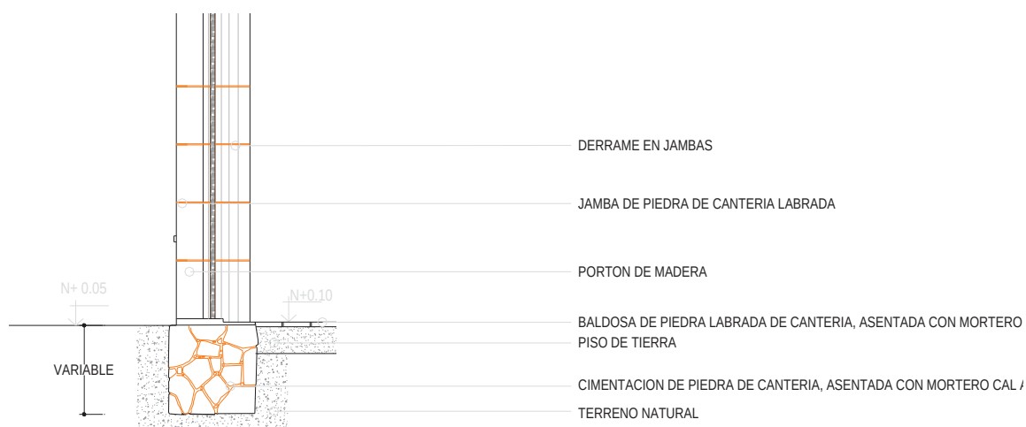
Imagen 71: Detalle de la cimentación en muros. (Elaboro: José A. Morales A.).
