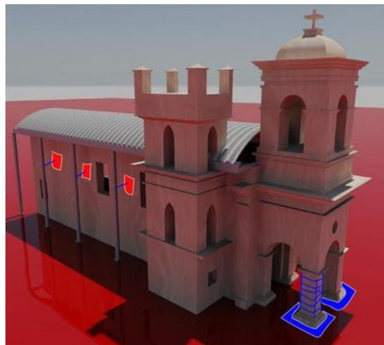
Figura 65 Ideas generales de intervención: propuesta de cubierta, refuerzo de cimentación y tensores en muro - elaborado por el autor
