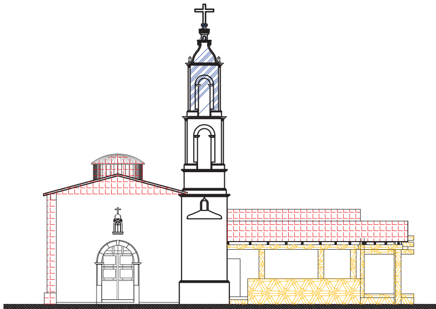
FACHADA PRINCIPAL OESTE. INTERVENCIONES POSTERIORES.
