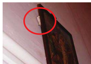
Figura 17. Colocación de Hobo en nave. Foto: MRBR.
