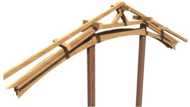
Ilustración 62. Estructura soportante de cubierta de templo. Detalle. Fuente: Fotografía del autor. 2012
