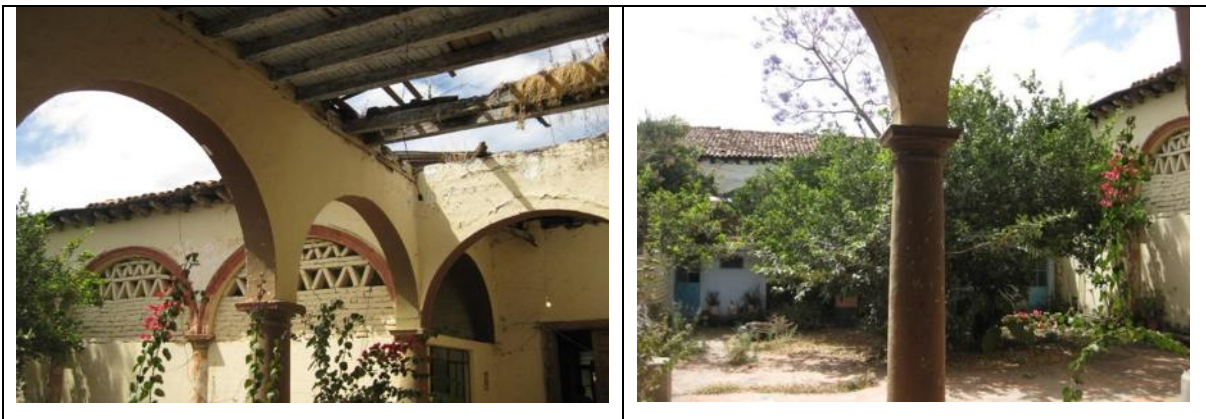
Imagen 123.- El patio central se convierte en el elemento principal para la incidencia ambiental en la vivienda, ya que es donde fluyen las ventilaciones principales así como los asoleamientos que regulan el confort térmico de los espacios. (Foto: G.A.B)
