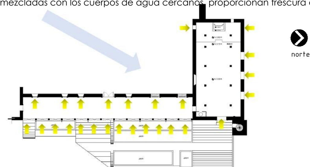
Fig. 36. Entradas de luz y ventilación natural al edificio. MCHB.
