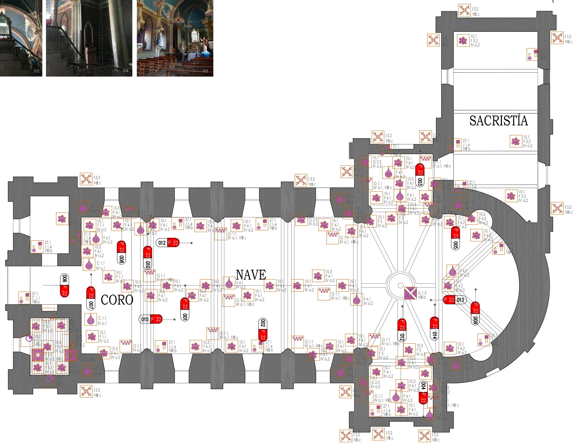
Alteraciones y Deterioros en planta de Techos.
